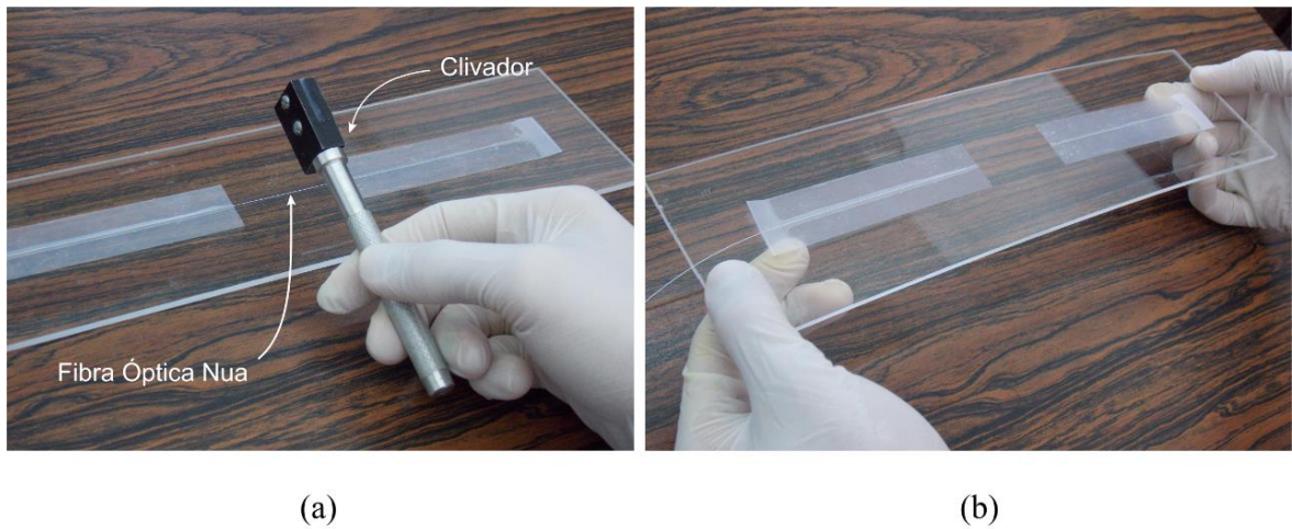
Figura 16 - Clivagem da fibra óptica. (a) Golpe com o clivador. (b) Divisão por forças de tração.
