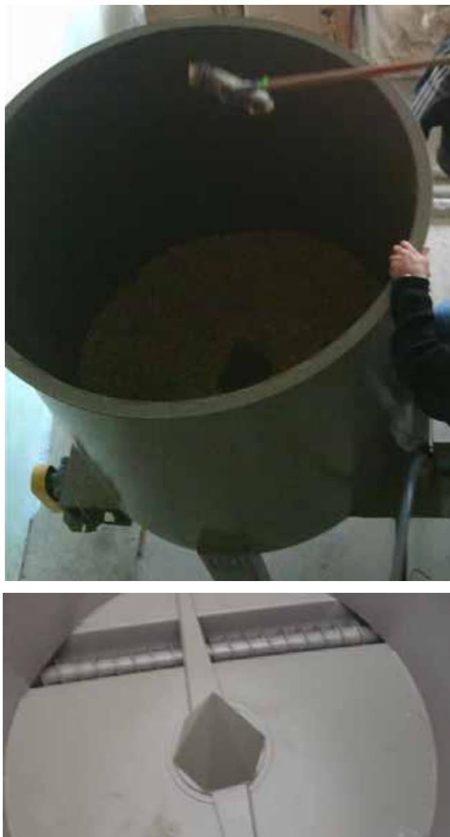
Figura 18. Reservatório de biomassa do queimador
