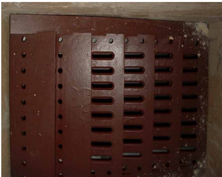
Figura 21. Grelha fixa para combustão de biomassa
