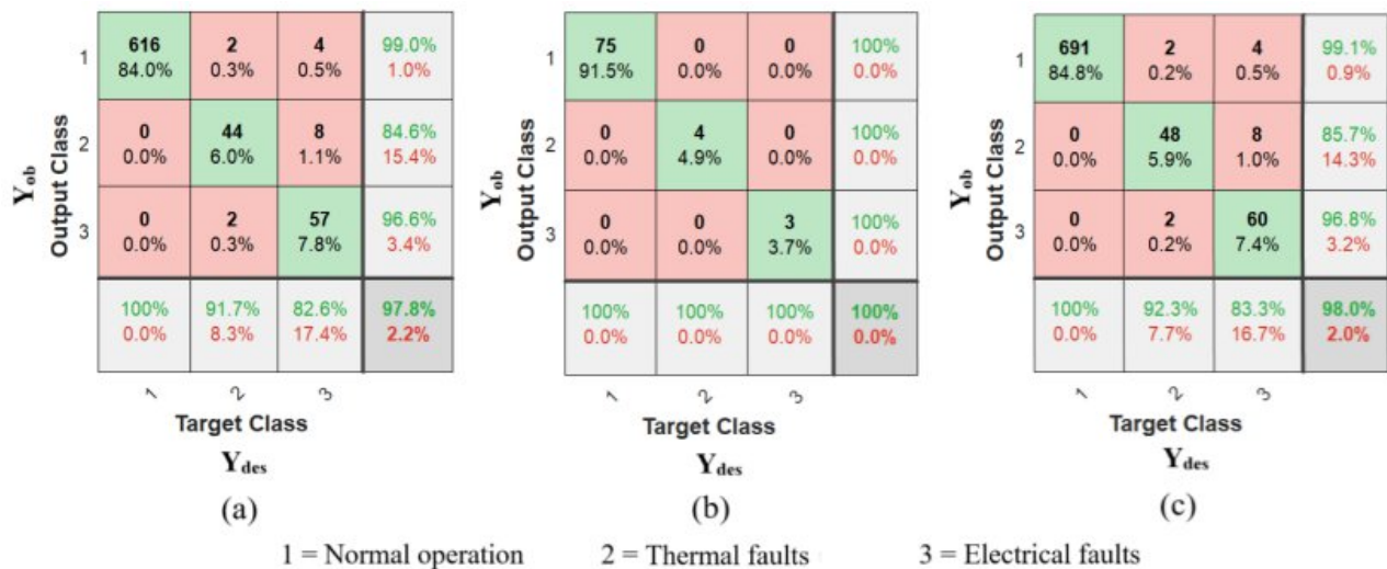
Figura 26. Matriz de confusão para classificar as três classes (1—condição operacional normal, 2—falhas térmicas, 3—falhas elétricas) obtidas pelo PRN com 10 neurônios na camada oculta, (a) fase de treinamento com 90% das amostras (733), (b) fase de validação com 10% das amostras (82), (c) 100% das amostras (815).
