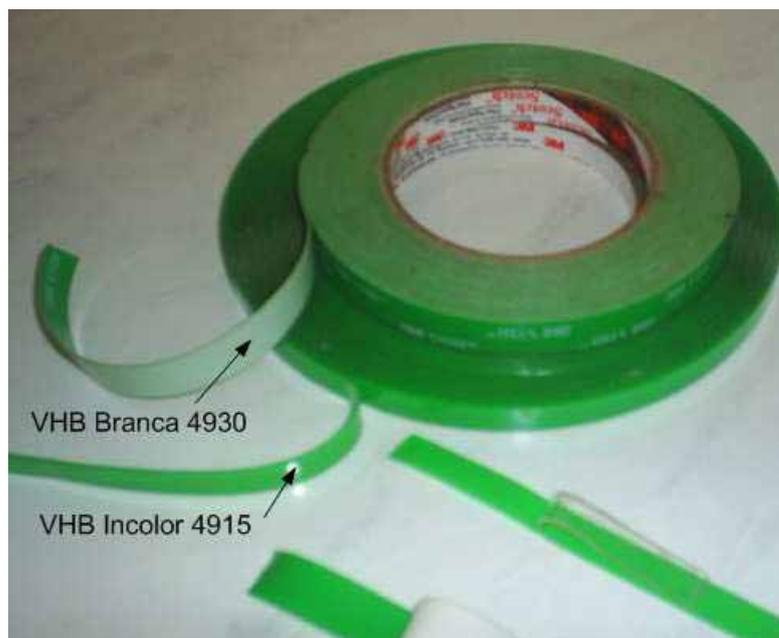
Figura 4.3 – Fitas VHB™ da 3M™ utilizadas como material viscoelástico
