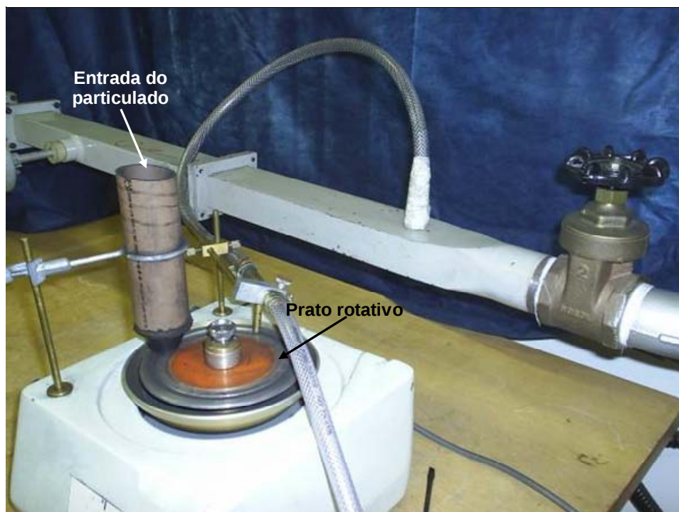
Figura 17 – Gerador de pó utilizado no aparato experimental
