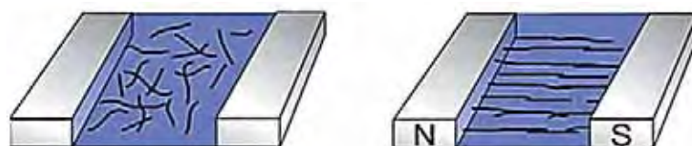
Figura 7 - Alinhamento de nanoestruturas 1D através de um campo magnético
