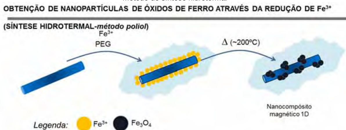
Figura 14 - Preparação de nanopartículas de óxido de ferro na superfície de nanoestruturas 1D pelo método de síntese hidrotermal
