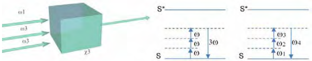
Figura 26 - Resposta de um material do tipo Kerr a uma radiação eletromagnética incidente de alta intensidade na geração de soma e diferença de frequências ou de terceiro harmônico
