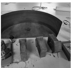
Figura 93 Envernizamento das partes da base. Foto: ca kobashi川.
