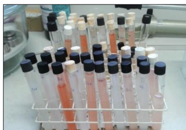
Figura 22 – Ensaio do potencial de biodegradação de hidrocarbonetos por P. putida CCMI 852 utilizando TTC, antes da leitura em espectrofotômetro.
