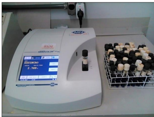
Figura 24 – Leitura dos ensaios colorimétricos em espectrofotômetro Nanocolor® UV/Vis-Macherey-Nagel a 600 nm.
