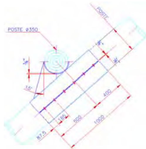
Apoio do contraventamento entre pórticos
