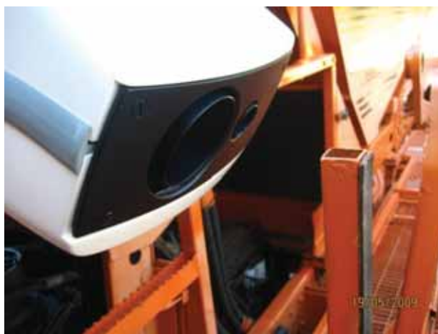
Figura 14 - Vista frontal da montagem do N-Sensor ALS no Uniport NPK Fonte: Máquinas Agrícolas Jacto S/A (2009)
