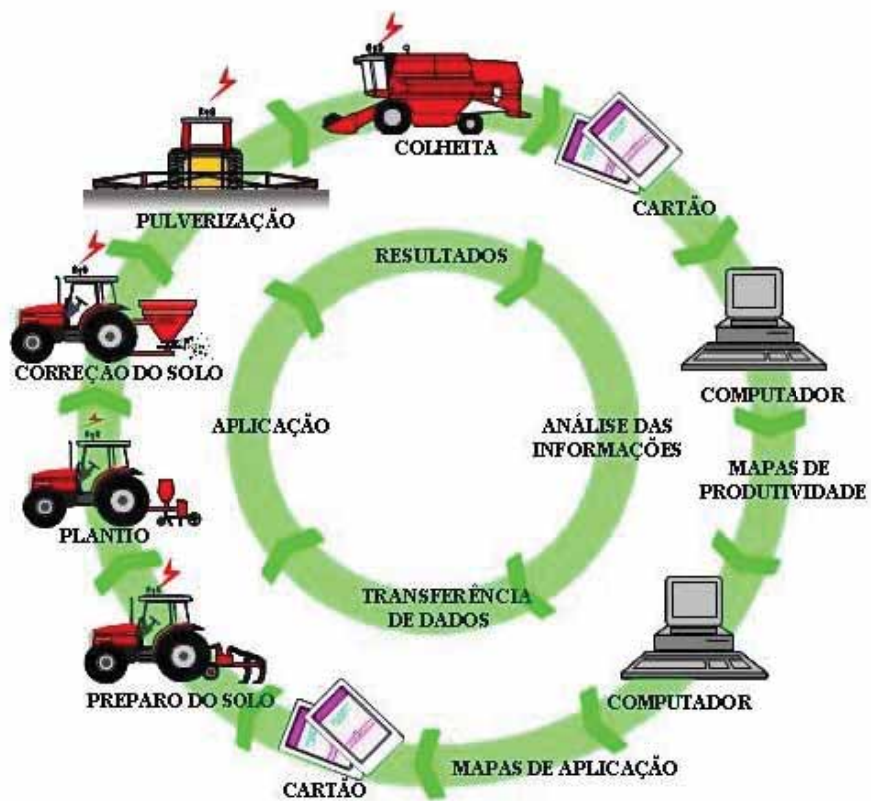
Figura 1 - Ciclo das tecnologias e máquinas envolvidas na Agricultura de Precisão Fonte: AGCO (2005)
