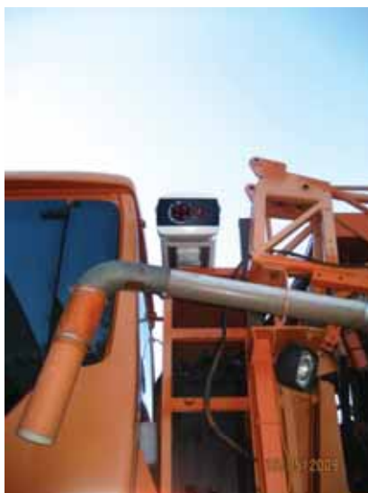
Figura 13 - Vista lateral da montagem do N-Sensor ALS no Uniport NPK Fonte: Máquinas Agrícolas Jacto S/A (2009)
