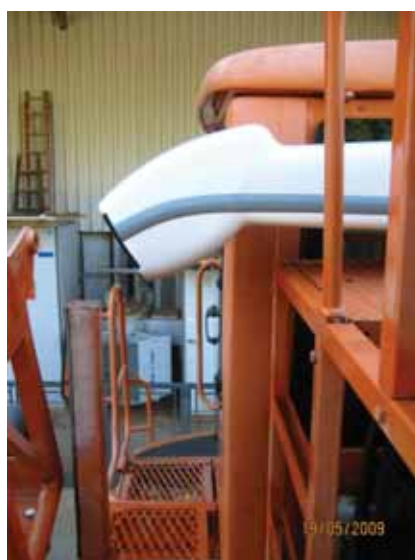
Figura 12 - Vista traseira da montagem do N-Sensor ALS no Uniport NPK Fonte: Máquinas Agrícolas Jacto S/A (2009)
