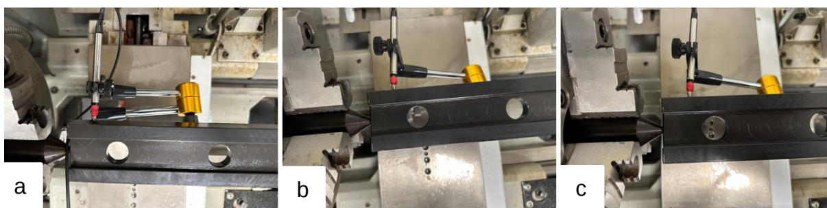
Figura 25 - Posição do LVDT após a reversão para (a) 0 mm, (b) 125 mm e (c) 250 mm
