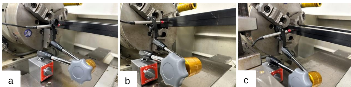
Figura 22 - Posição do LVDT anterior a reversão para (a) 0 mm, (b) 125 mm e (c) 250 mm
