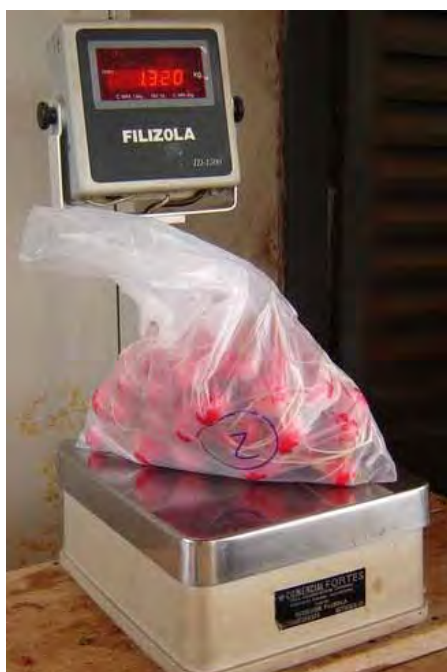
Figura 14. Pesagem de matéria fresca em balança digital.
