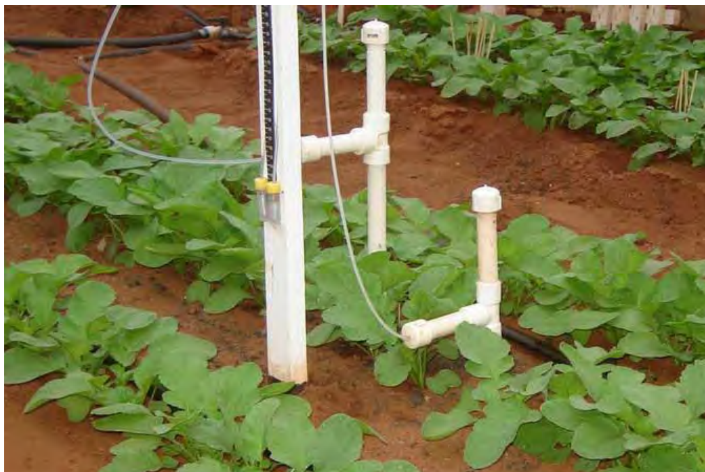
Figura 8: Tensiômetros de decisão e de controle, instalados na cultura de rabanete.
