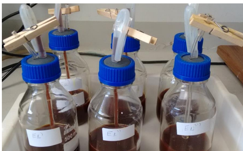
Figura 3 - Frasco reator com adaptação de dispositivo para entrada e saída de gases
