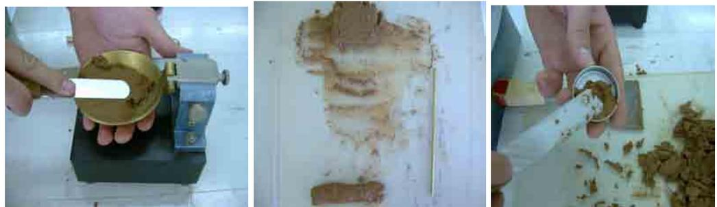
Fotos 8, 9 e 10. Execução dos ensaios de Limites de Consistência (Liquidez, Plasticidade e Contração)
