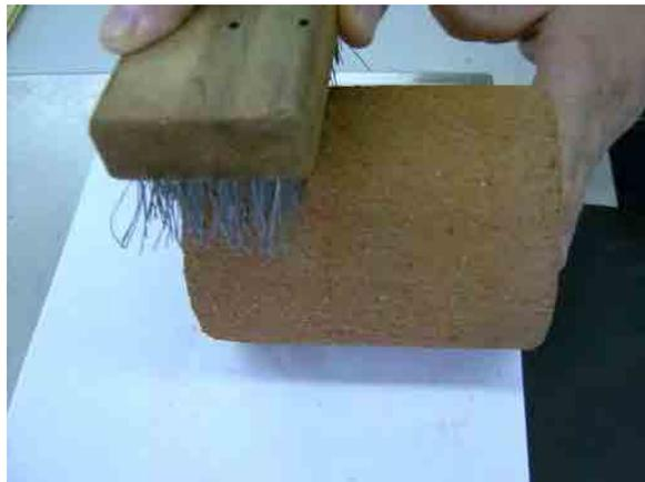
**Foto 14. Processo de escovação durante o ensaio de durabilidade.**
