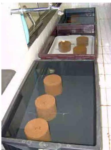
**Foto 12. Ensaio de absorção de água dos corpos de prova**
