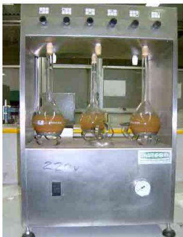
**Foto 6. Determinação da Massa Específica pelo Método do Picnômetro**
