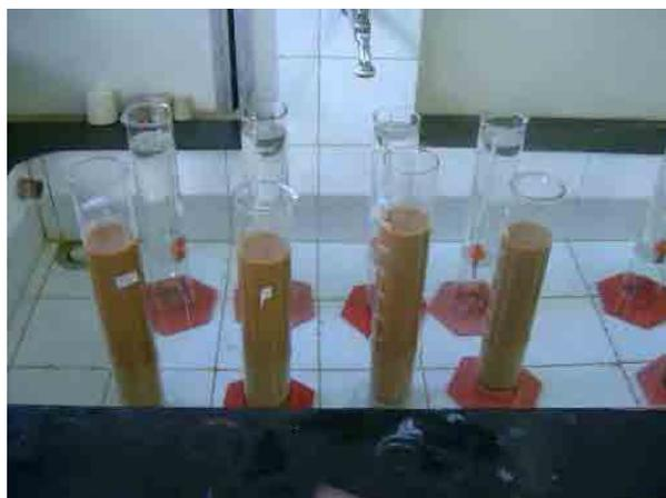
**Foto 7. Ensaio de Granulometria Combinada (sedimentação)**
