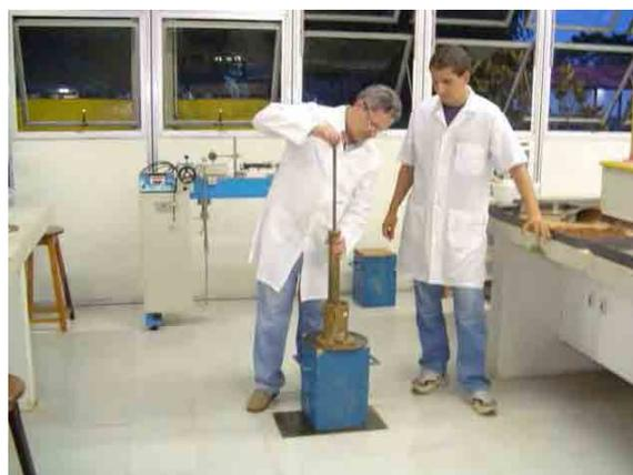
Foto 11. Ensaio de compactação (Proctor)
