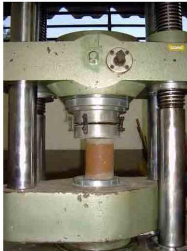
**Foto 13. Ensaio de resistência à compressão**
