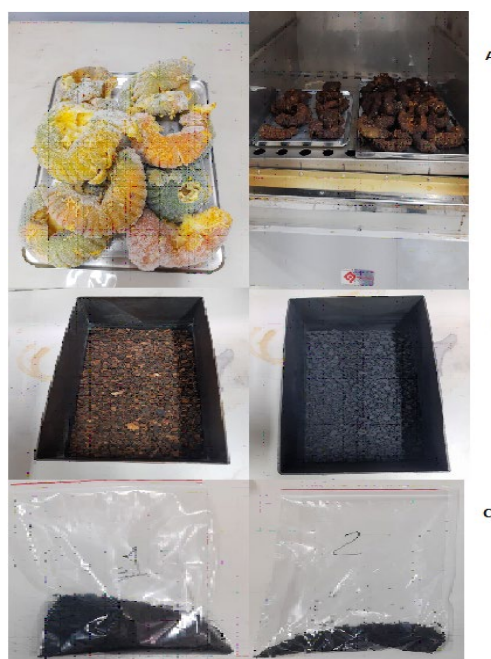
Figura 5. A) Tratamento térmico; B) Pirólise C) Separação granulométrica.
