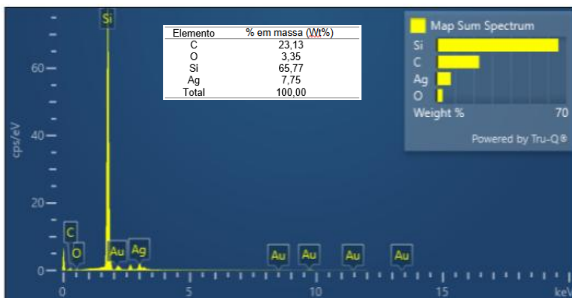
Figura 18 - Espectro de EDX e composição elementar das AgNPs da formulação 1:09pHc
