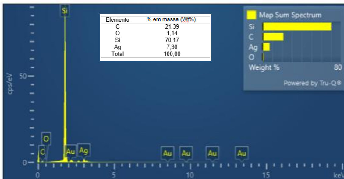
Figura 17 - Espectro de EDX e composição elementar das AgNPs da formulação 1:19pHc
