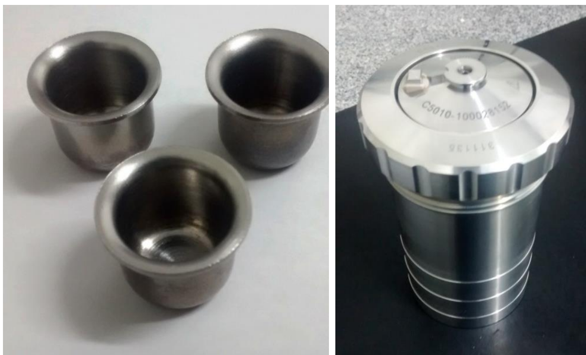
Figura 15 - Componentes para a análise de PCS: (a) cadinhos de aço inox e (b) vaso pressurizado
