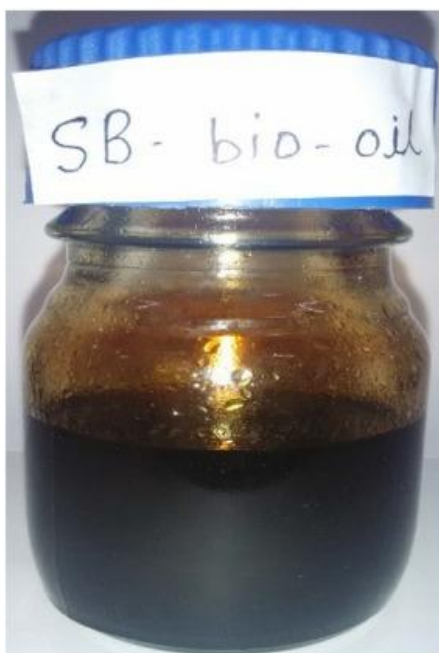
Figura 7 – Bio-óleo obtido através da pirólise lenta.
