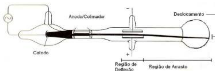
Figura 2 - Visão esquemática do aparelho de Thomson [7]. “Raios” repelidos pelo catodo são atraídos pelo anodo e alguns passam pelo colimador, formando um feixe. Esse feixe é defletido por placas ligadas a uma bateria, de modo a formar um forte campo elétrico entre elas; depois, move-se em uma região livre de forças, até bater na parede do tubo, produzindo um ponto de luz.
