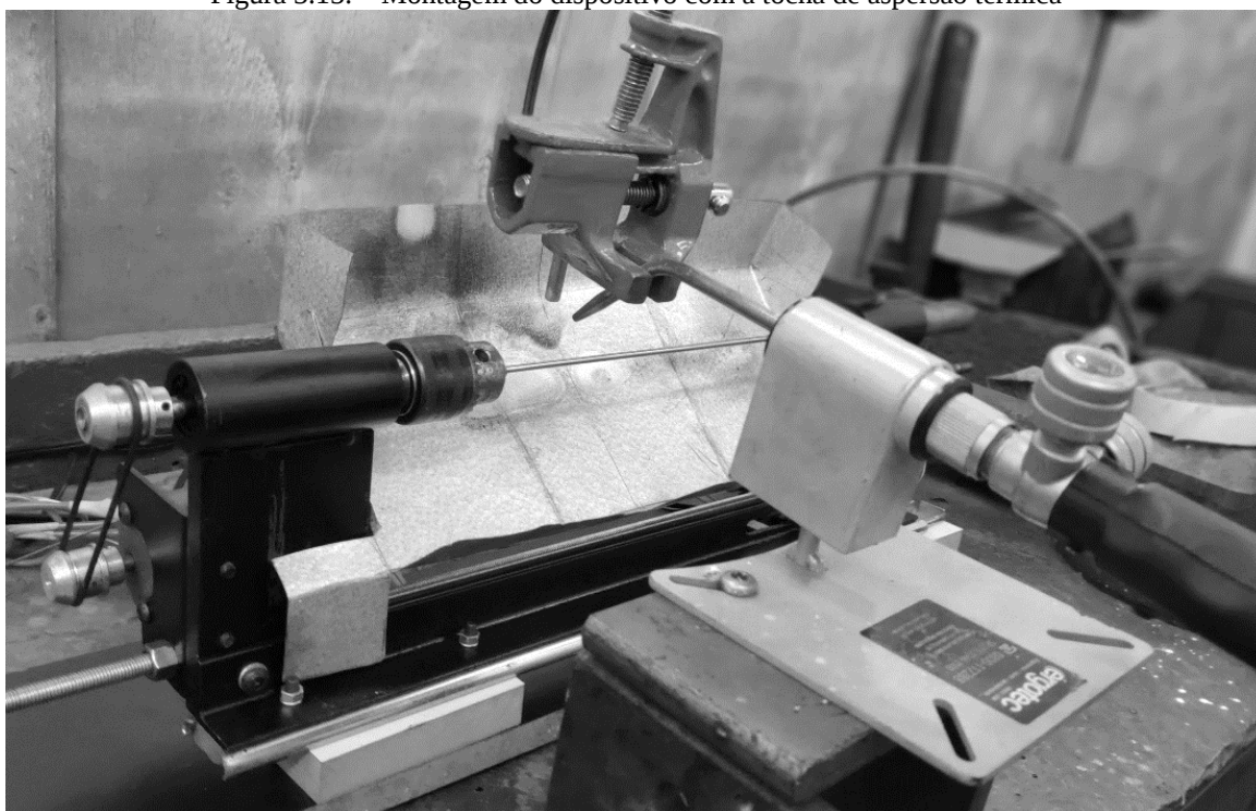
Figura 3.13. – Montagem do dispositivo com a tocha de aspersão térmica
