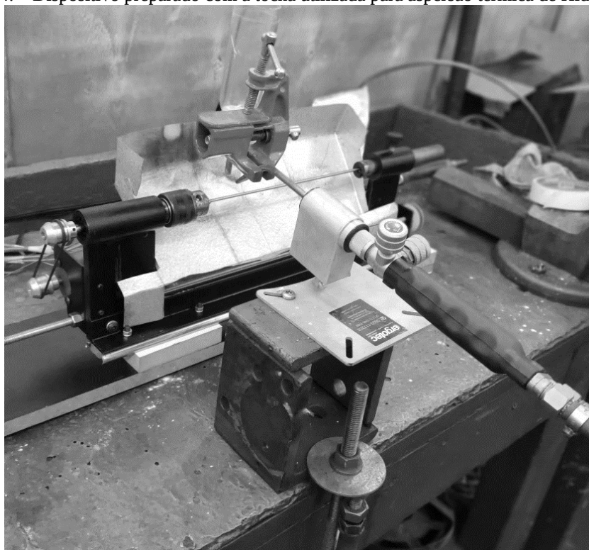
Figura 4.4. – Dispositivo preparado com a tocha utilizada para aspersão térmica de Hidroxiapatita
