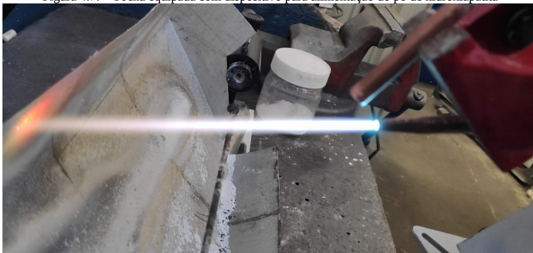
Figura 4.7. – Tocha equipada com dispositivo para alimentação do pó de hidroxiapatita
