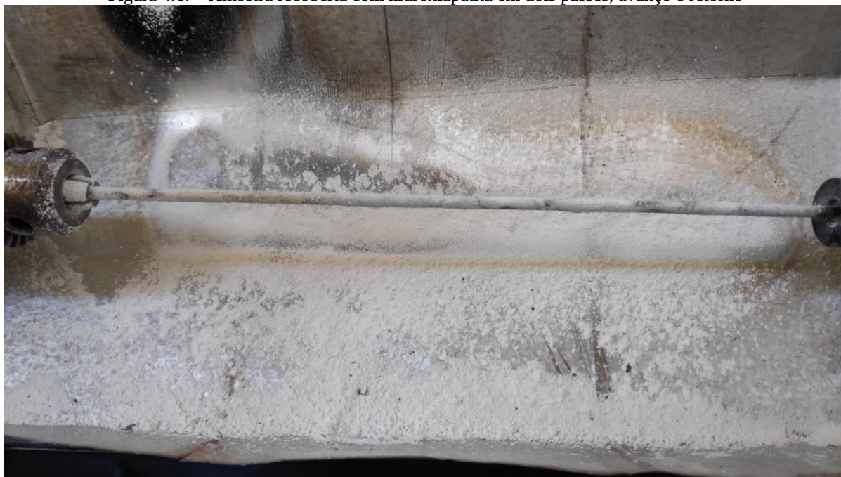
Figura 4.6. – Amostra recoberta com hidroxiapatita em dois passes, avanço e retorno
