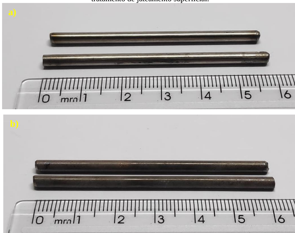
Figura 3.1. – Amostras de liga Ti-6Al-4V. a) amostra sem nenhum tratamento superficial. b) amostra com tratamento de jateamento superficial.
