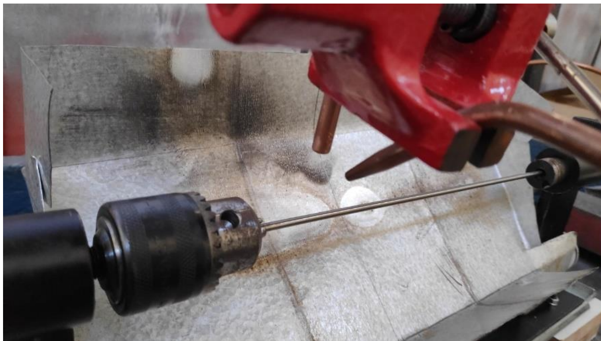
Figura 4.3. – Configuração do dispositivo para recobrimento
