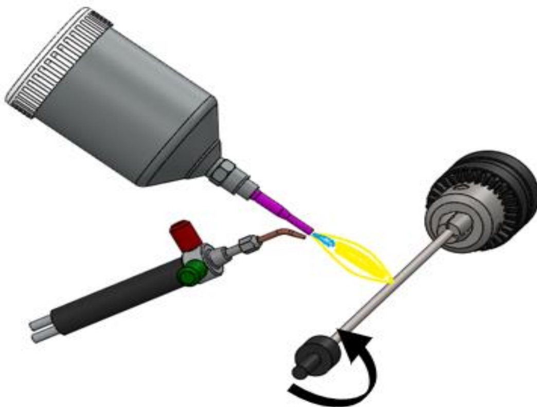
Figura 3.15. – Imagem ilustrativa do processo de aspersão térmica
