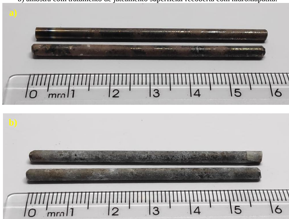
Figura 3.2. – Amostras de liga Ti-6Al-4V. a) amostra revestida com hidroxiapatita sem jateamento superficial. b) amostra com tratamento de jateamento superficial recoberta com hidroxiapatita.
