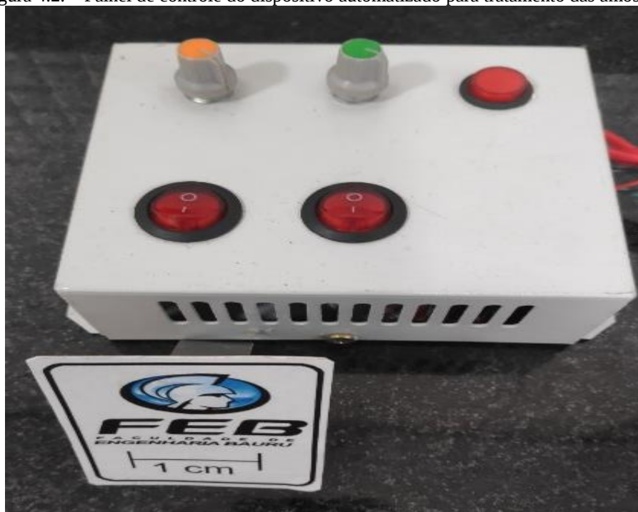
Figura 4.2. – Painel de controle do dispositivo automatizado para tratamento das amostras
