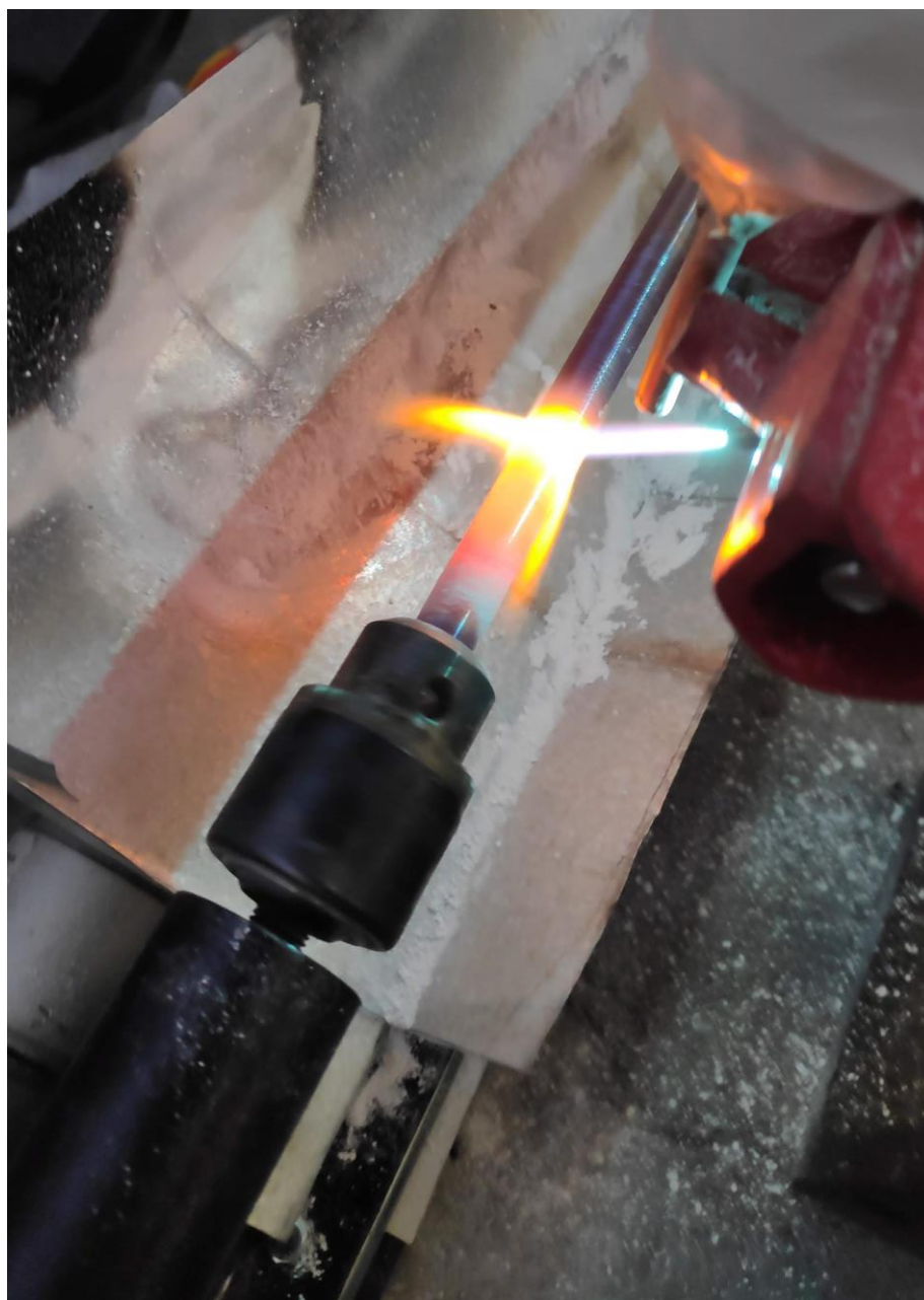
Figura 4.5. – Retorno da tocha de aspersão térmica pulverizando a hidroxiapatita no substrato.
