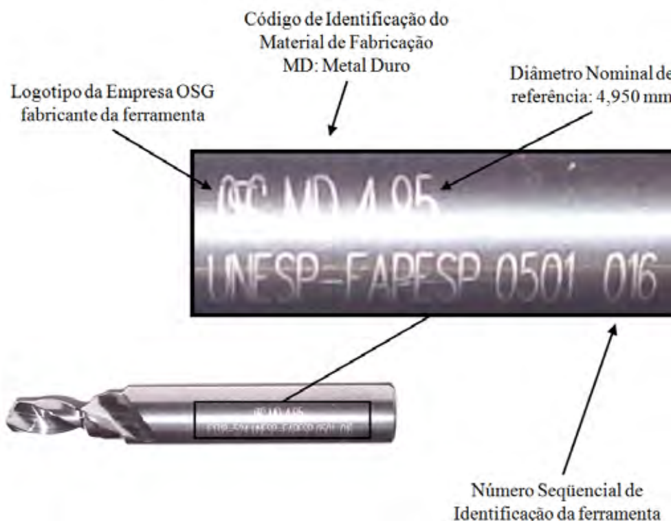
Figura 16. Broca helicoidal de metal duro da empresa OSG utilizada para realização dos ensaios
