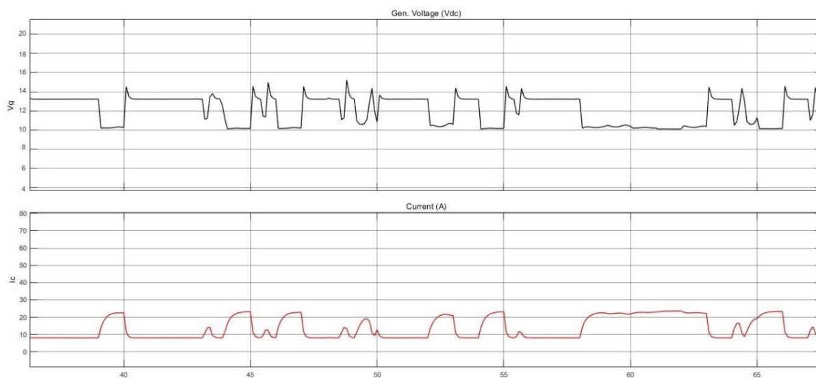
Figura 64 – Gráfico com os sinais V_g e I_c com o controle implementado.
