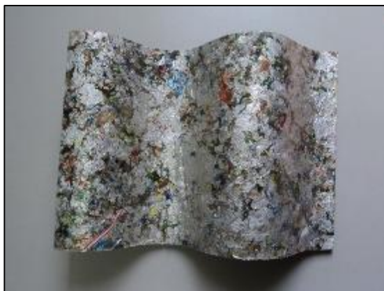
Figura 48- Telha ecológica feita de Embalagem Longa-vida (Tetra Pak)
