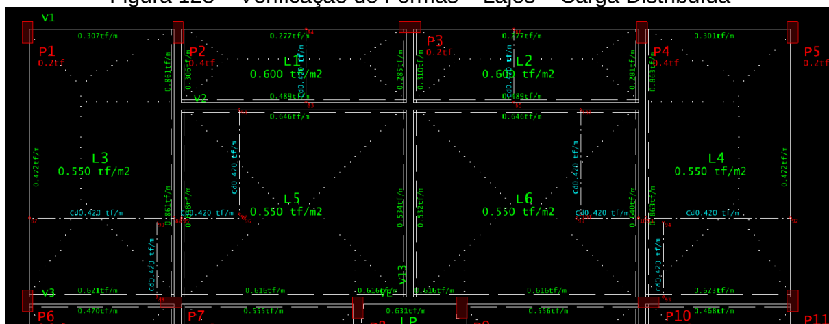
Figura 128 – Verificação de Formas – Lajes – Carga Distribuída
