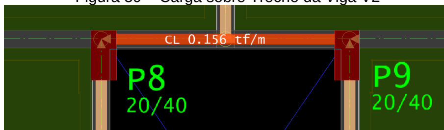
Figura 59 – Carga sobre Trecho da Viga V2
