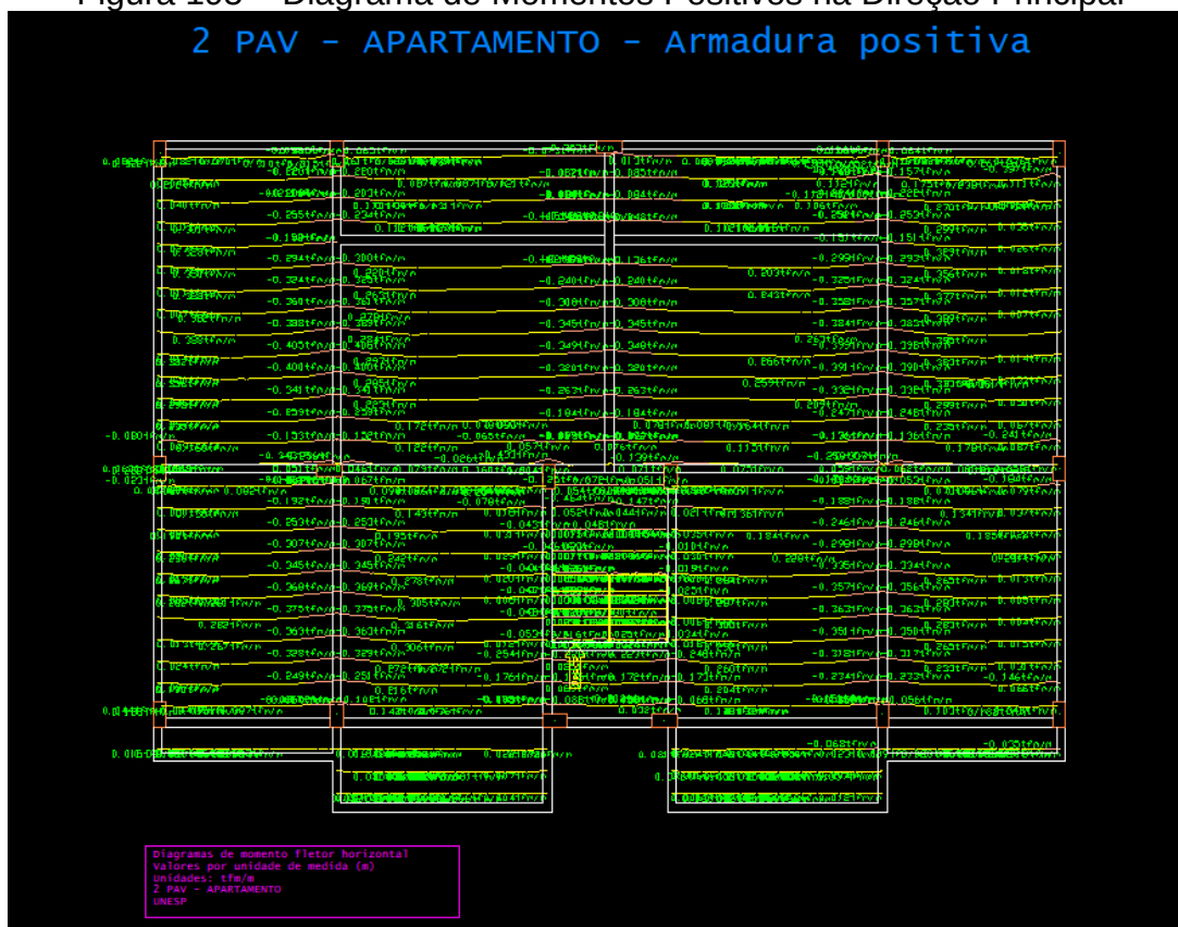
Figura 195 – Diagrama de Momentos Positivos na Direção Principal
