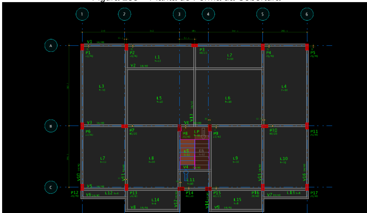
Figura 235 – Planta de Forma da Cobertura
