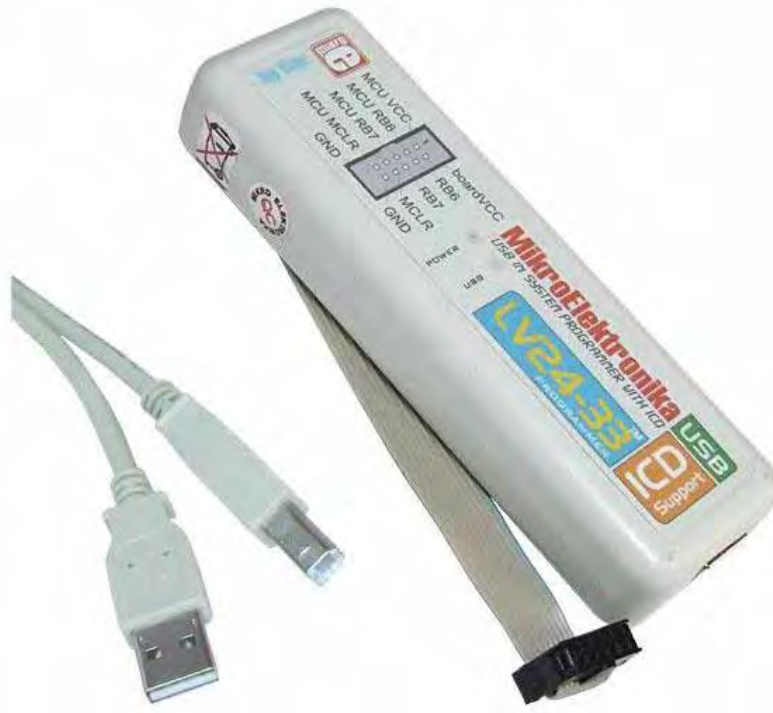
Figura 17 – LvPICFlash utilizado no projeto
