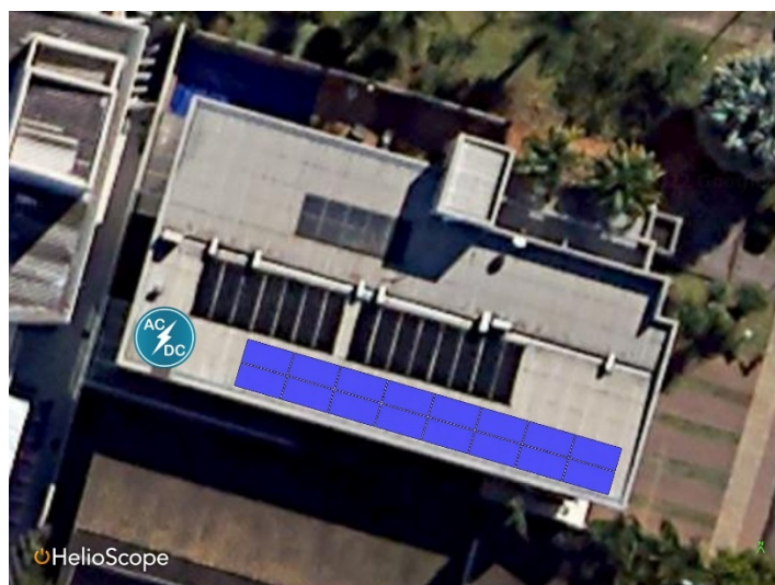
Figura 17 – Alocação dos módulos no HelioScope
