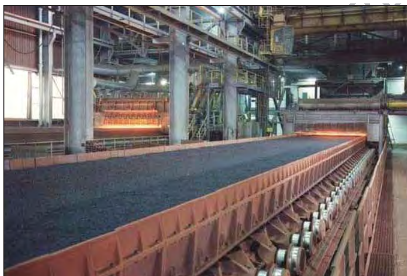
Figura 4.1 – Máquina de sinterização processo Dwight-Lloyd com forno de ignição ao fundo
