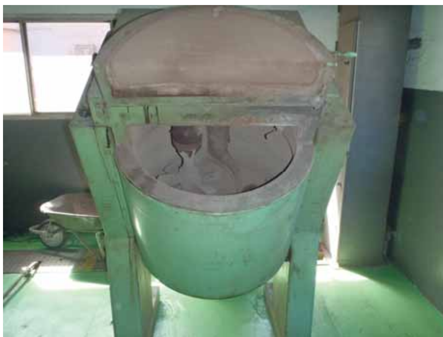
Figura 6.4 – Tambor rotativo para preparação das amostras
