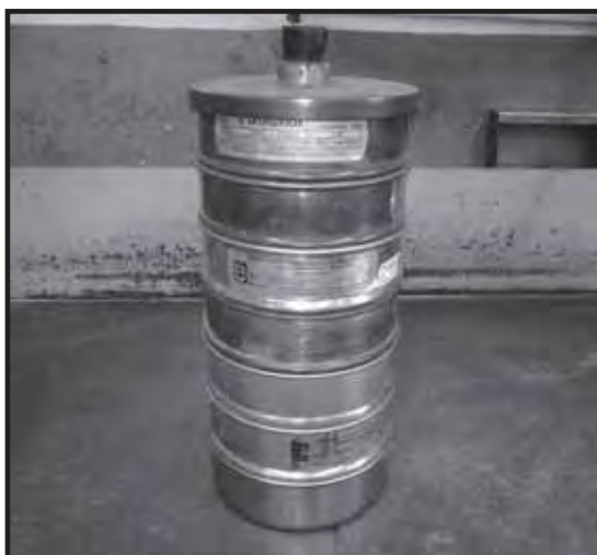
Figura 6.7 – Testes de peneiramento conforme norma NBR ISO 4701
