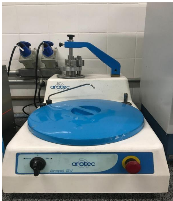
Figura 9: Máquina usada neste trabalho, para lixar e polir as amostras
