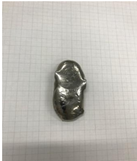
Figura 4: Fotografia do lingote da liga Zr-20Ta-5Ti, após fusão a arco-voltaico.
