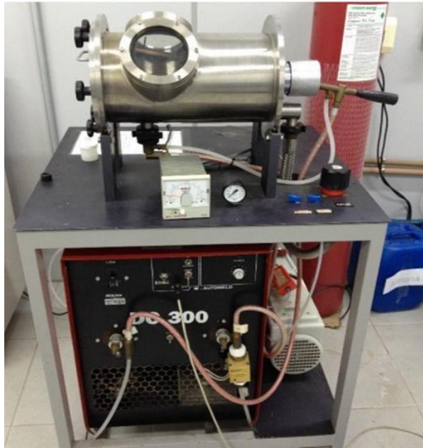
Figura 3: Forno de fusão a arco-voltaico utilizado neste trabalho.
