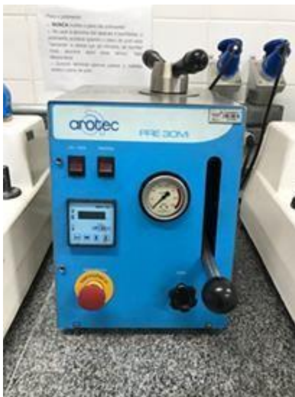
Figura 7: Máquina usada neste trabalho, para embutir as amostras.
