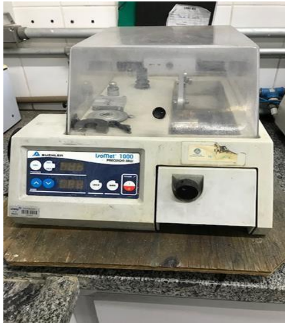
Figura 5: Máquina usada neste trabalho para o corte das amostras.
