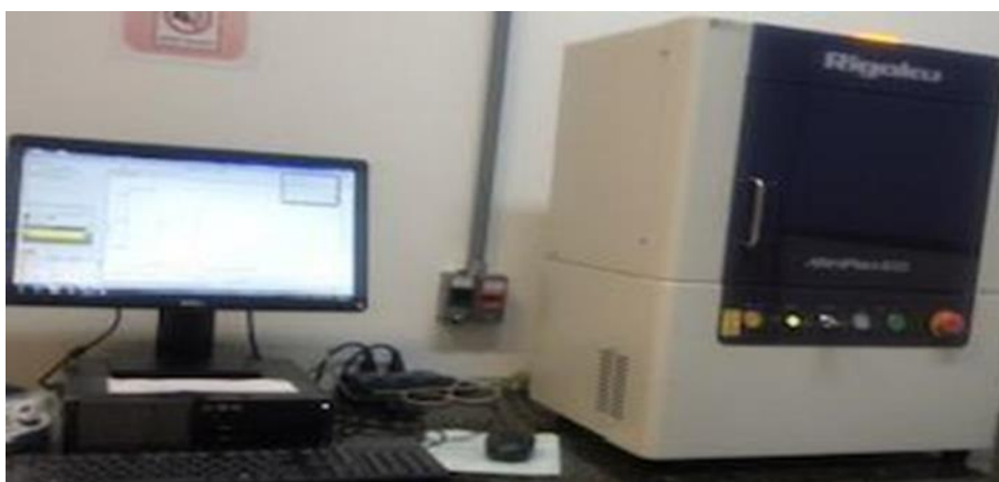
Figura 6: Equipamento usado neste trabalho, para medidas de difração de raios X.
