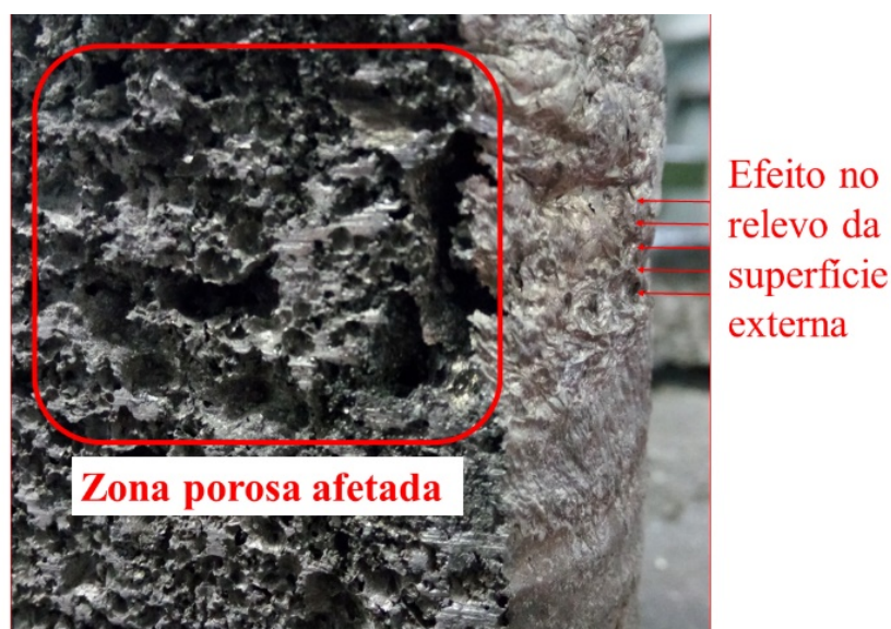
Figura 55- Influência na superfície externa devido a coalescência e desestabilidade da estrutura porosa
