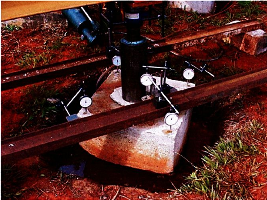
Foto 4.7. Sistema de referencia composto por dois perfis "I".
