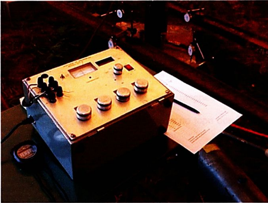
Foto 4.6. Indicador de Deformação.
