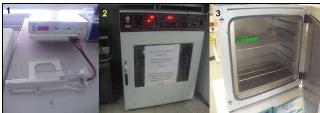
Figura 2.9: Transformação: 1. Aparelho de eletroporação; 2. Câmara de agitação; 3. Incubadora (37°C)
