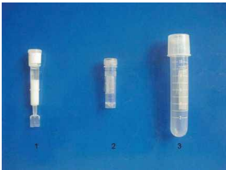
Figura 2.7: Integrantes do kit: 1. coluna cromatográfica; 2. tubo de adaptação; 3. tubo para adaptação ao rotor
