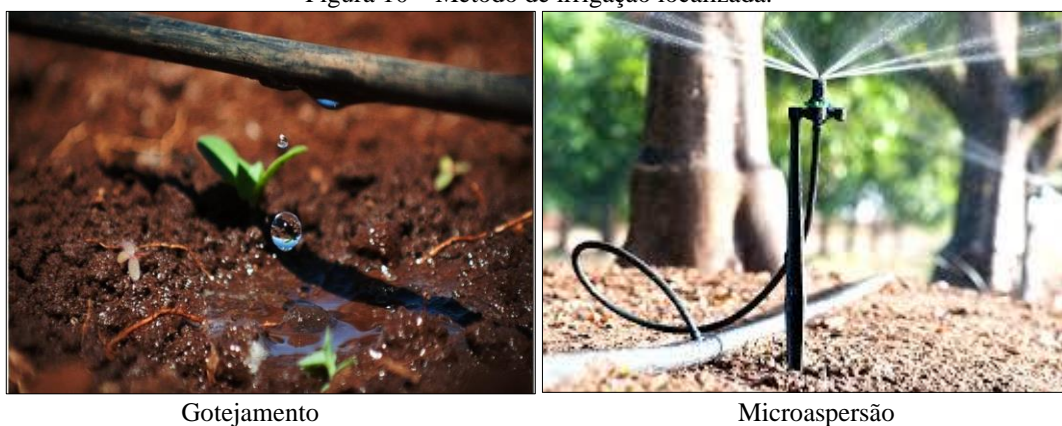
Figura 10 – Método de irrigação localizada.
