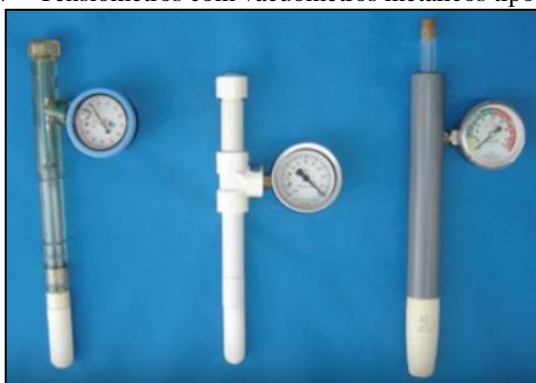
Figura 27 – Tensiômetros com vacuômetros metálicos tipo Bourdon.
