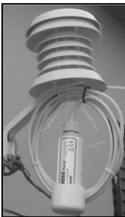
Figura 8 - Abrigo meteorológico (RS3 – Hobo) com registrador de temperatura e umidade – data logger (U23-002) Hobo
