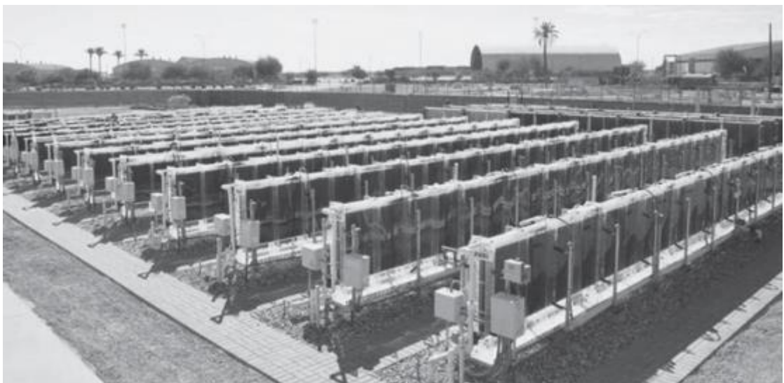
Figura 02. Fotobiorreatores flat panel feitos em vidro na Universidade do Arizona (EUA).
