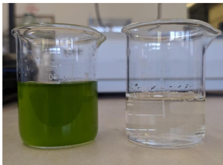
Figura 09. Amostras retiradas do flat panel : Bruta à esquerda e filtrada pelas membranas 1,2 \mu\text{m} e 0,45 \mu\text{m} à direita.
