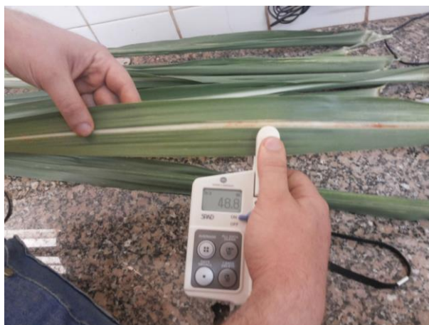
Figura 8 – Clorofilômetro, SPAD-502, leitura em folha +3 de cana-de-açúcar
