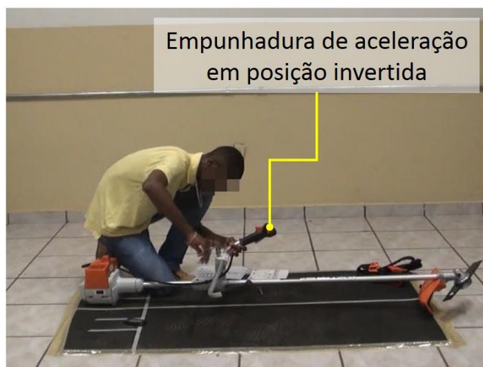
Figura 51 – Empunhadura de aceleração montada em posição invertida (lado esquerdo).
