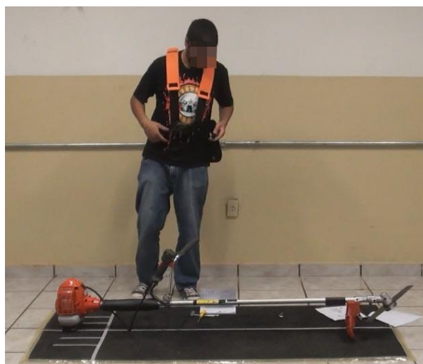
Figura 45 - Vestimenta do cinto com espuma das alças e pad de proteção invertidos.
