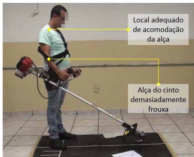
Figura 55 – Alça direita do cinto demasiadamente frouxa. Peso total do equipamento suportado apenas por uma alça.
