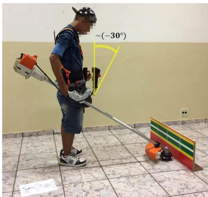
Figura 91 – Sistema C/E. Montagem das empunhaduras em angulação inadequada.
