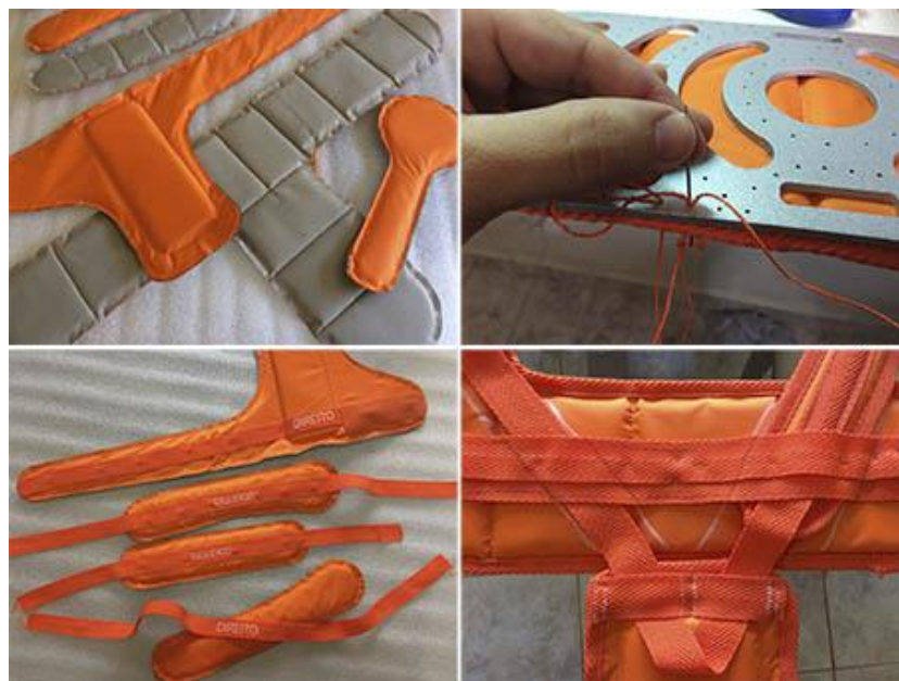
Figura 82 – Algumas etapas do processo de confecção do novo cinto de sustentação.
