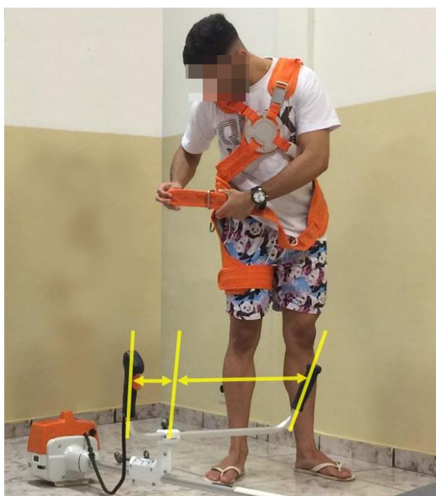
Figura 96 – Sistema F/F. Vestimenta da alça de quadril. Empunhaduras montadas de maneira correta.
