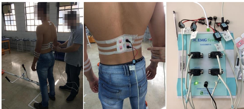
Figura 35 – Posicionamento dos eletrodos e respectivas conexões ao módulo de aquisição de sinais.
