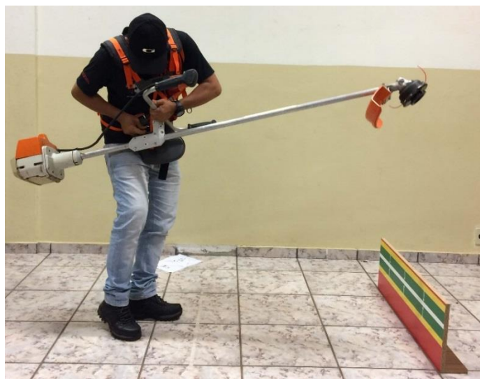
Figura 93 – Sistema C/E. Tentativa de movimentação do suporte de sustentação/empunhaduras com o equipamento empunhado ao corpo.
