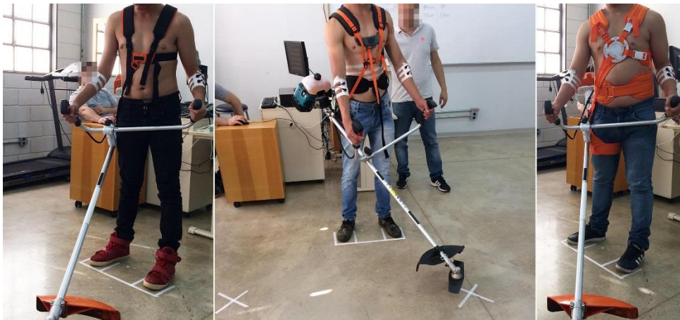
Figura 36 – Simulação dos movimentos com uma RLM, exceto pernas e pés.
