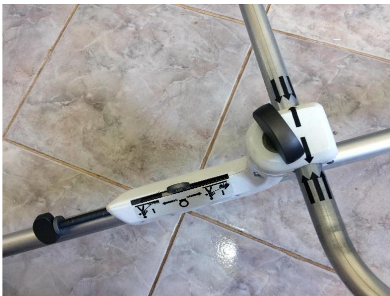
Figura 95 – Sistema F/F – Montagem correta das empunhaduras.
