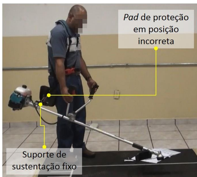
Figura 49 – Pad de proteção da perna direita em local inadequado.
