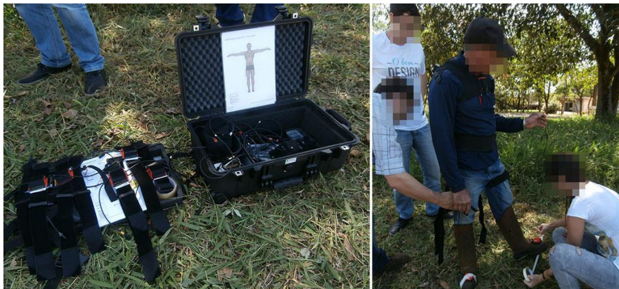
Figura 25 –Tecnologia de captura de movimentos por inércia e instalação do equipamento ao corpo do operador.
