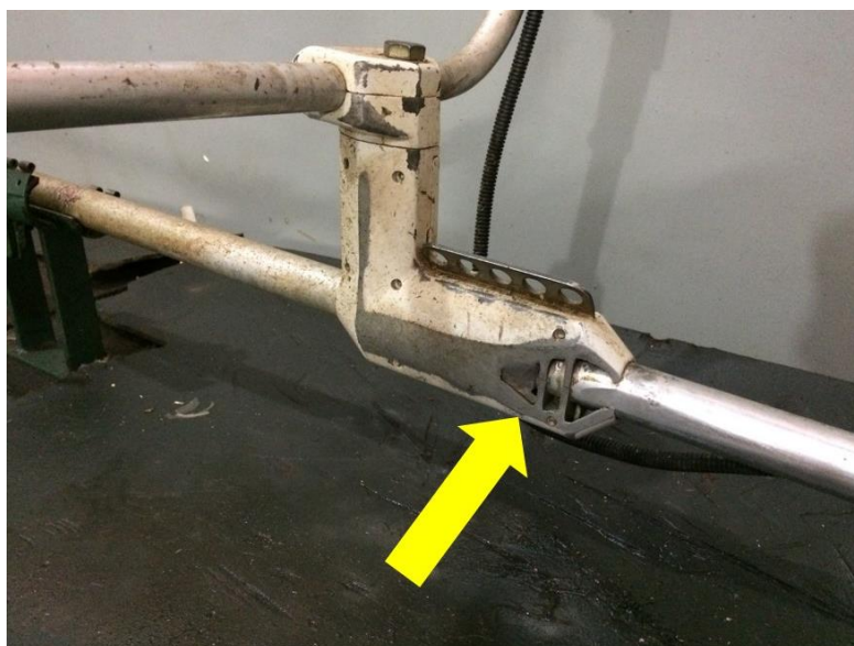
Figura 48 – Desgaste de um suporte de sustentação decorrente de sucessivos movimentos em contato com a perna do usuário.
