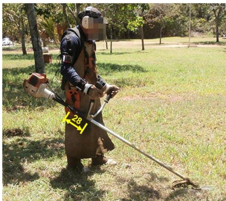
Figura 39 – Operador em atividade. Suporte de sustentação a 28cm de distância do suporte das empunhaduras.
