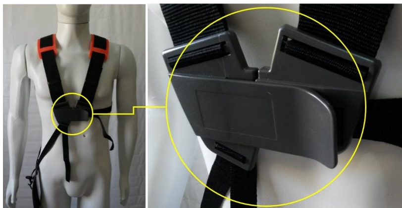
Figura 58 – Cinto A – presilha frontal com desenho pouco usual.
