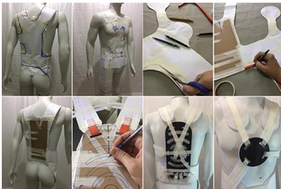
Figura 81 – Algumas etapas do processo de modelagem do cinto de sustentação.
