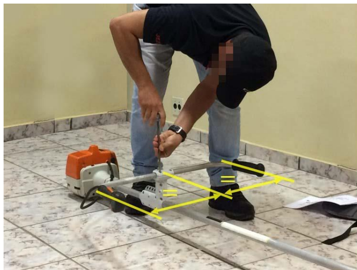
Figura 92 – Sistema C/E. Empunhaduras montadas simetricamente em relação à haste principal do equipamento.
