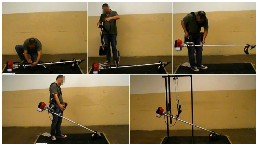
Figura 27 – Etapas de montagem do sistema de sustentação da RLM e a acoplagem desta ao dispositivo de mensuração de forças, projetado conforme Apêndice 18.
