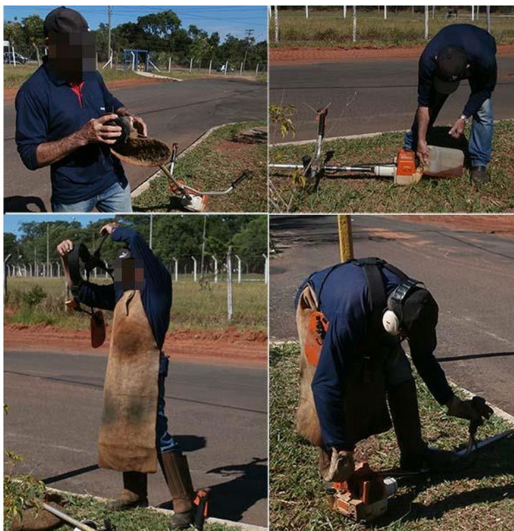
Figura 38 – Tarefas elementares realizadas pelo operador. Ausência do procedimento de balanceamento da máquina.
