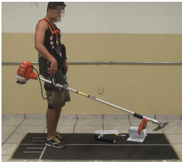
Figura 43 – Montagem incorreta das empunhaduras. A angulação provocou uma pega inadequada.
