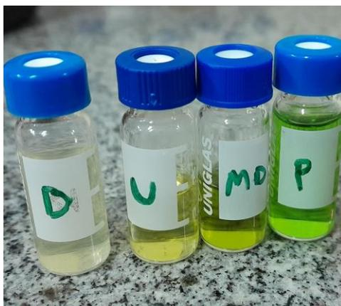
**Figura 6-** Amostra em *vials*; d:decocção, u:ultrassom, md: maceração dinâmica e p: percolação
