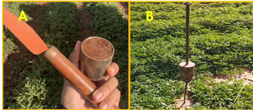
Figura 5 – a) Cilindro extrator de amostras indeformadas; b) penetrômetro de impacto no solo.
