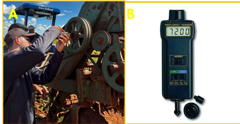
Figura 4 - Avaliação da rotação por minuto da esteira vibratória. a) Rotação das roldanas; b) Tacômetro digital.
