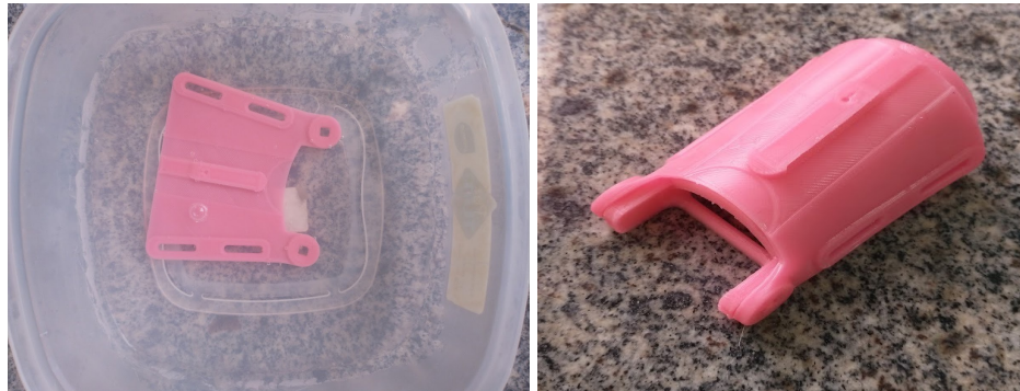
Figura 19 - Processo de termoformagem da manopla Unlimbted Phoenix Hand Fonte: Autoria própria.
