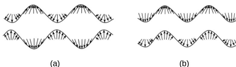
Figura 6 – Ilustração do comportamento das superfícies quando o modo de propagação simétrico (a) e assimétrico (b) se propagam na placa
