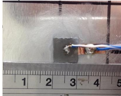
Figura 16 – Transdutor PZT modelo T110-H4e-62 fabricado pela Piezo Systems, Inc. e cortado em quadrado com medida de 10mm de lado.
