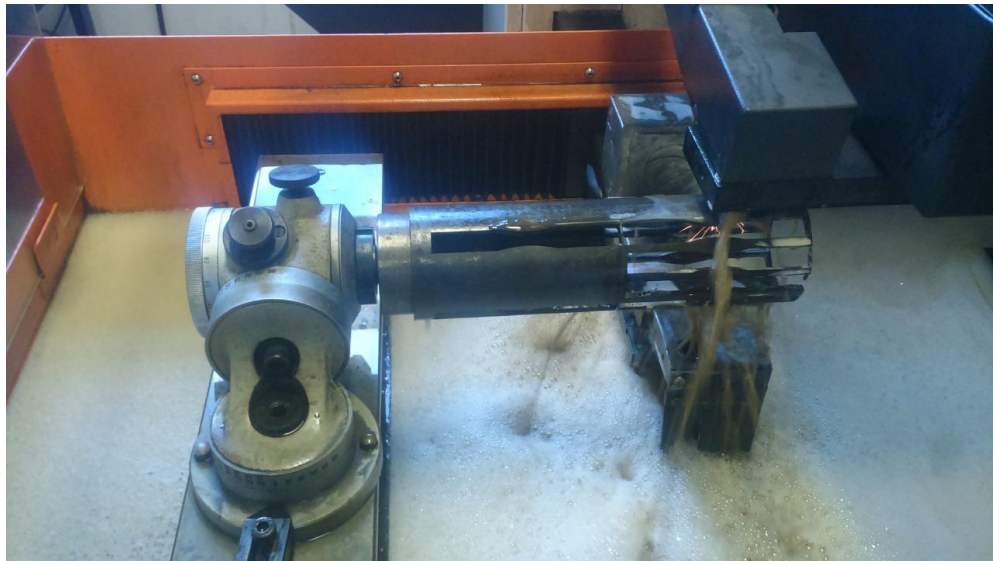
Figura 16 - Usinagem, via processo de eletroerosão a fio, dos corpos de prova utilizados nos ensaios de tração.
