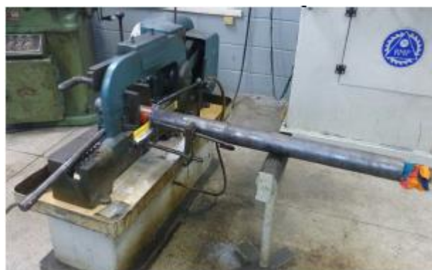
Figura 14 - Tubo de aço API N80 tipo Q sendo seccionado com utilização de uma serra hidráulica da Oficina Mecânica do Departamento de Materiais e Tecnologia da FEG/UNESP.
