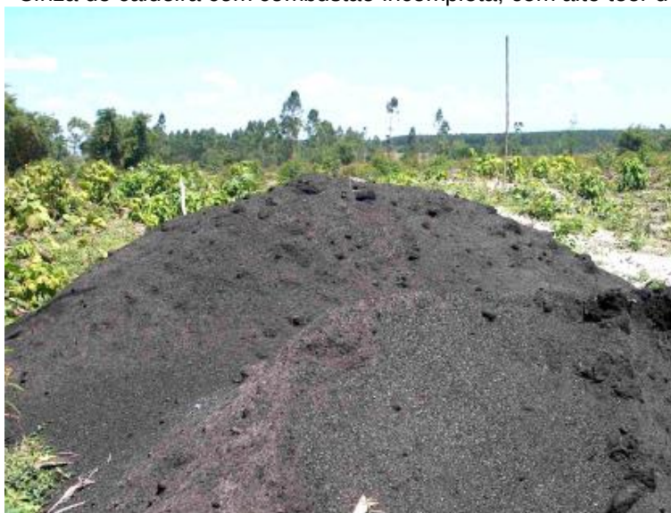
Figura 4 – Cinza de caldeira com combustão incompleta, com alto teor de carbono.
