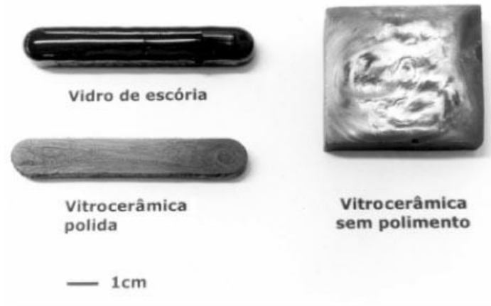
Figura 16 – Vitrocerâmicas produzidas com escória de aciaria
