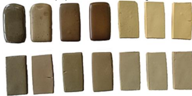
Figura 15 – Vitrocerâmicas preparadas com resíduos de granito e mármore
