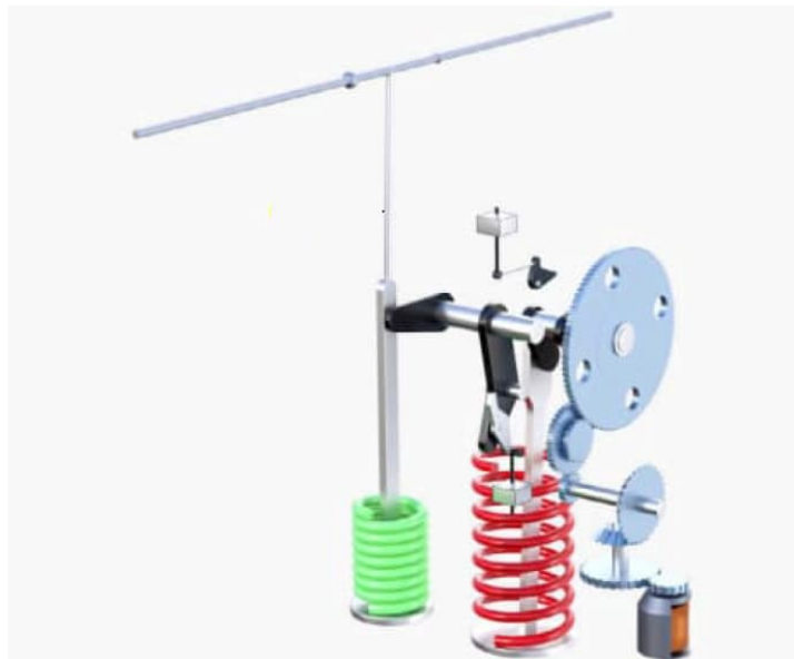
Figura 15 – Mecanismo de acionamento à mola para disjuntor de alta tensão
