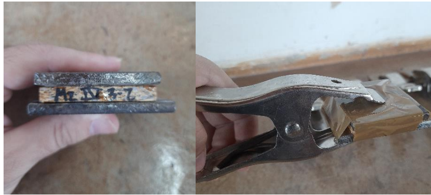
Figura 17 – (a) Cp colado na chapa metálica; (b) Cp com fita adesiva e pinça metálica
