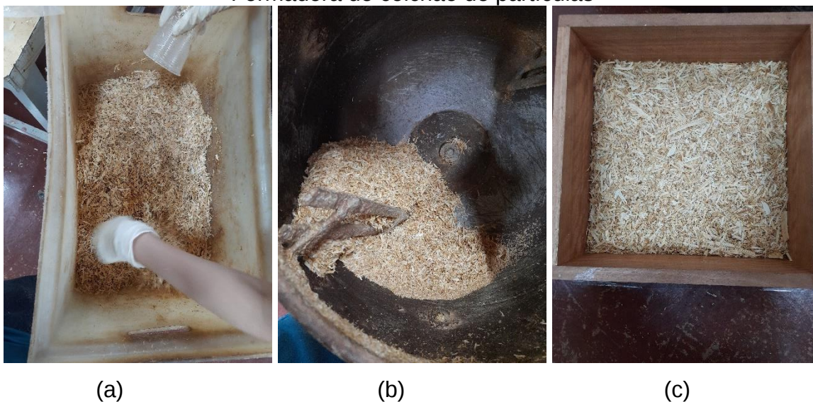
Figura 9 – (a) Adição de resina; (b) Homogeneização em tambor rotatório; (c) Formadora de colchão de partículas
