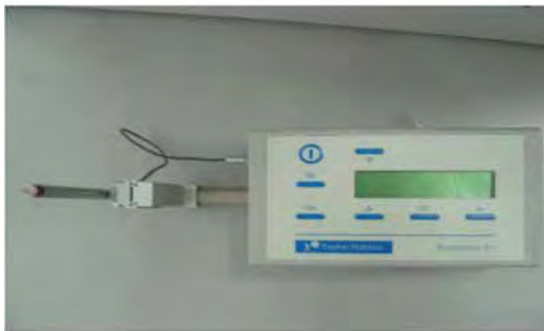
Figura 3.22- Rugosímetro utilizado na medição da rugosidade
