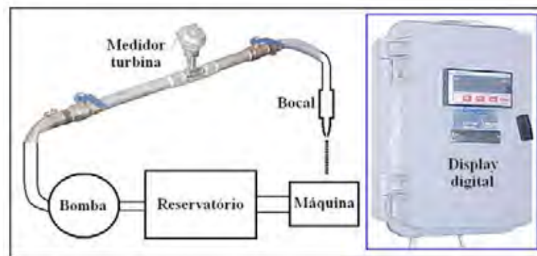
Figura 3.16- Esquema do sistema para medição e calibração da vazão no sistema de aplicação de fluido otimizado.
