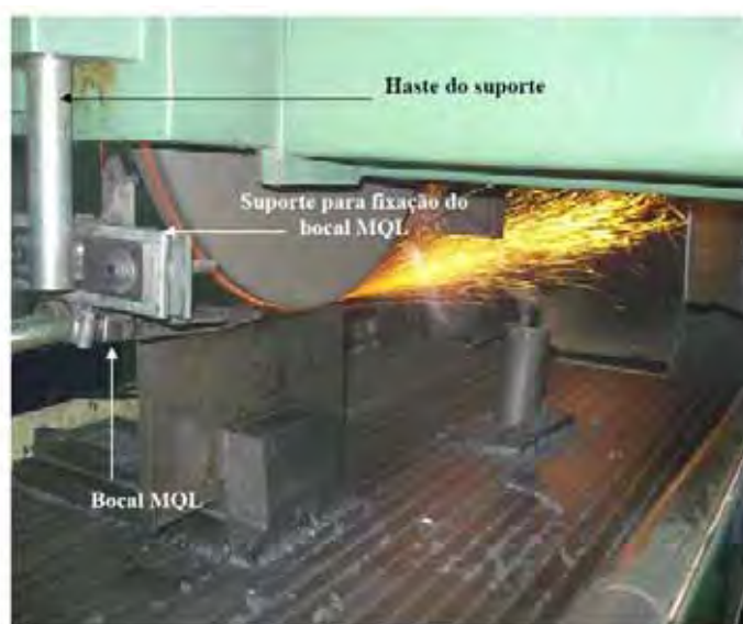
Figura 3.14 - Disposição geral do sistema rebolo/peça/bocal MQL e máquina empregados nos testes com a técnica MQL.
