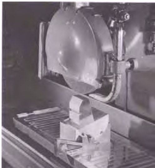
Figura 2.23 – Bocal de aplicação convencional de fluido de corte (MOLTRETCH, 1979).
