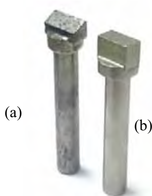
Figura 3.3 – Dressador estático do tipo conglomerado de diamante utilizado nesta pesquisa: (a) dressador gasto; (b) dressador novo.
