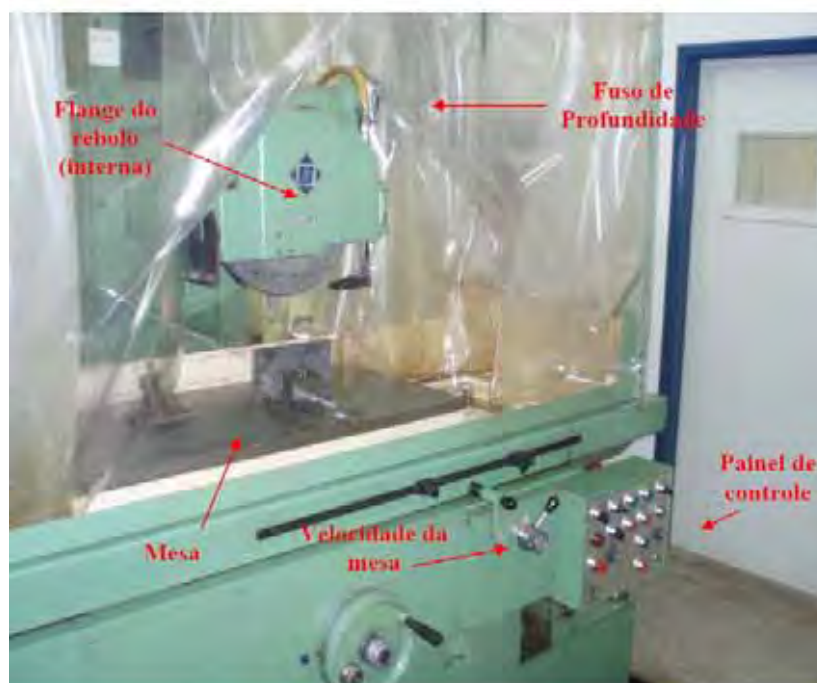
Figura 3.18- Máquina retificadora plana universal utilizada nos ensaios.
