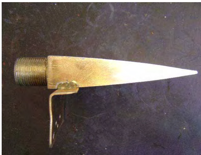
Figura 3.15 - O bocal projetado para sistema otimizado de fluido de corte.
