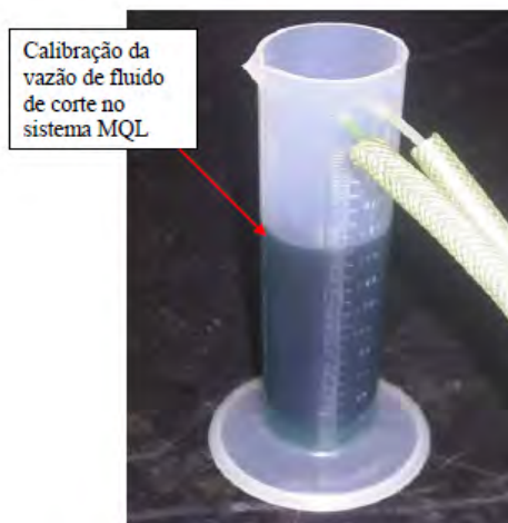
Figura 3.13- Proveta utilizada na calibração da vazão do fluido de corte no sistema MQL.
