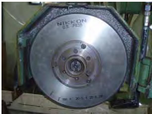
Figura 3.2 – Rebolo de cBN fixado no cabeçote da retificadora.
