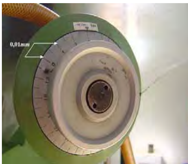
Figura 3.20- Detalhe do nônio do fuso de controle da profundidade de corte.
