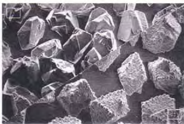
Figura 2.14 – cBN: a – Tipo I; b- Tipo II – GE Superabrasives (KRAR & RATTERMAN, 1990).
