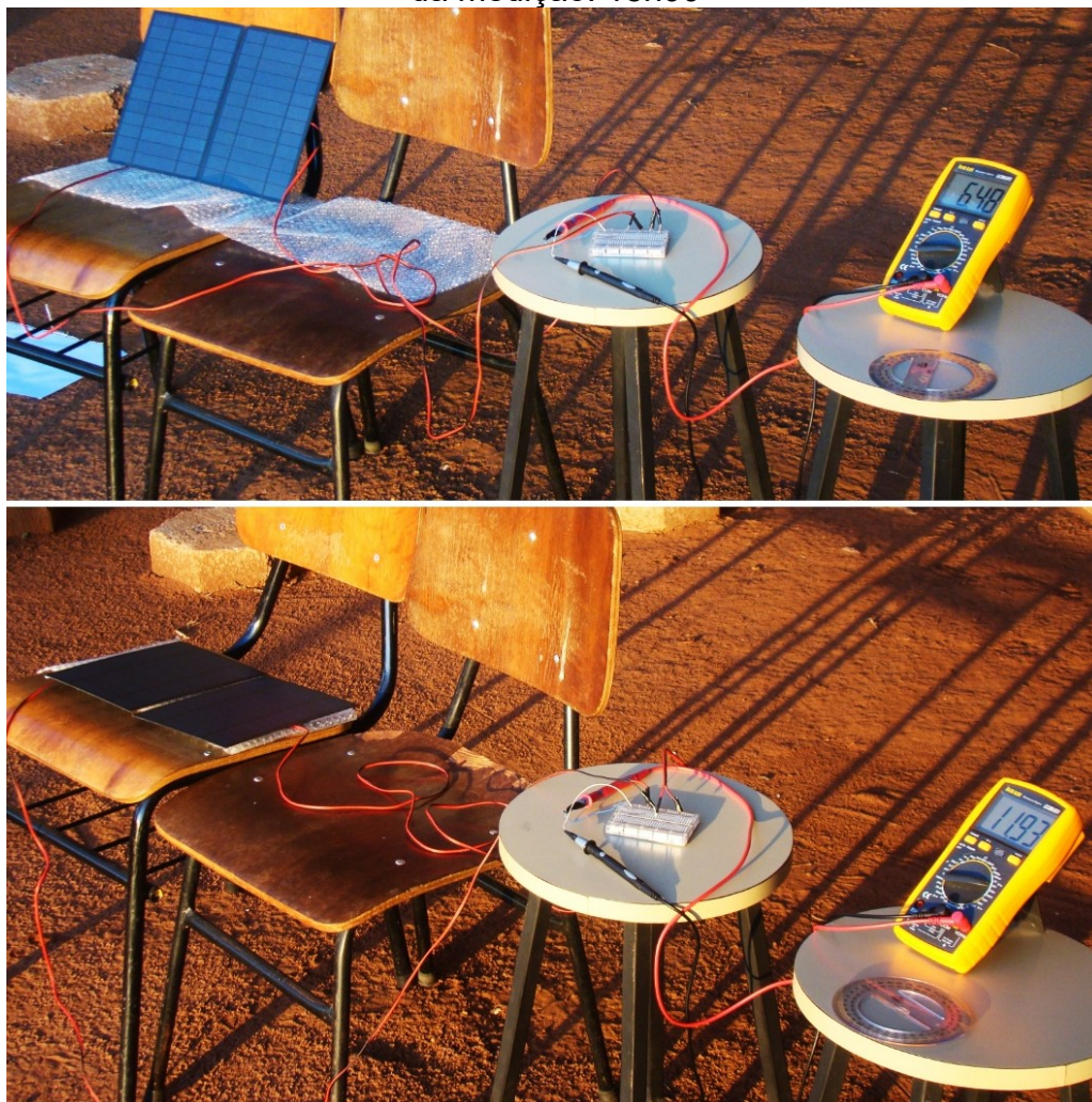
Figura 36: Ligação em paralelo e série das células fotovoltaicas. Hora da medição: 18h00
