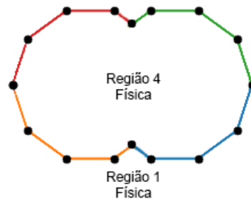
Figura 14 – Remoção da região não-física e das curvas que a formam.
