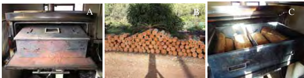
Figura 5. Forno elétrico com termopares (A). Amostras de madeiras sadias e doentes para carbonização no forno elétrico (B) Madeira enfiada para ignição do processo de carbonização (C).
