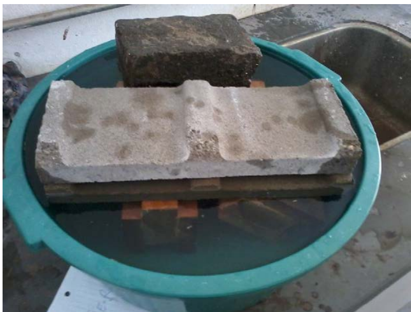
Figura 10 – Corpos de prova imersos em água
