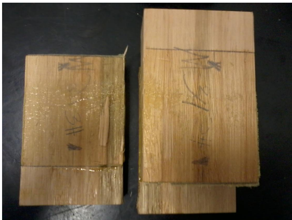
Figura 16 – Modo de ruptura predominante na colagem a 14% de teor de umidade
