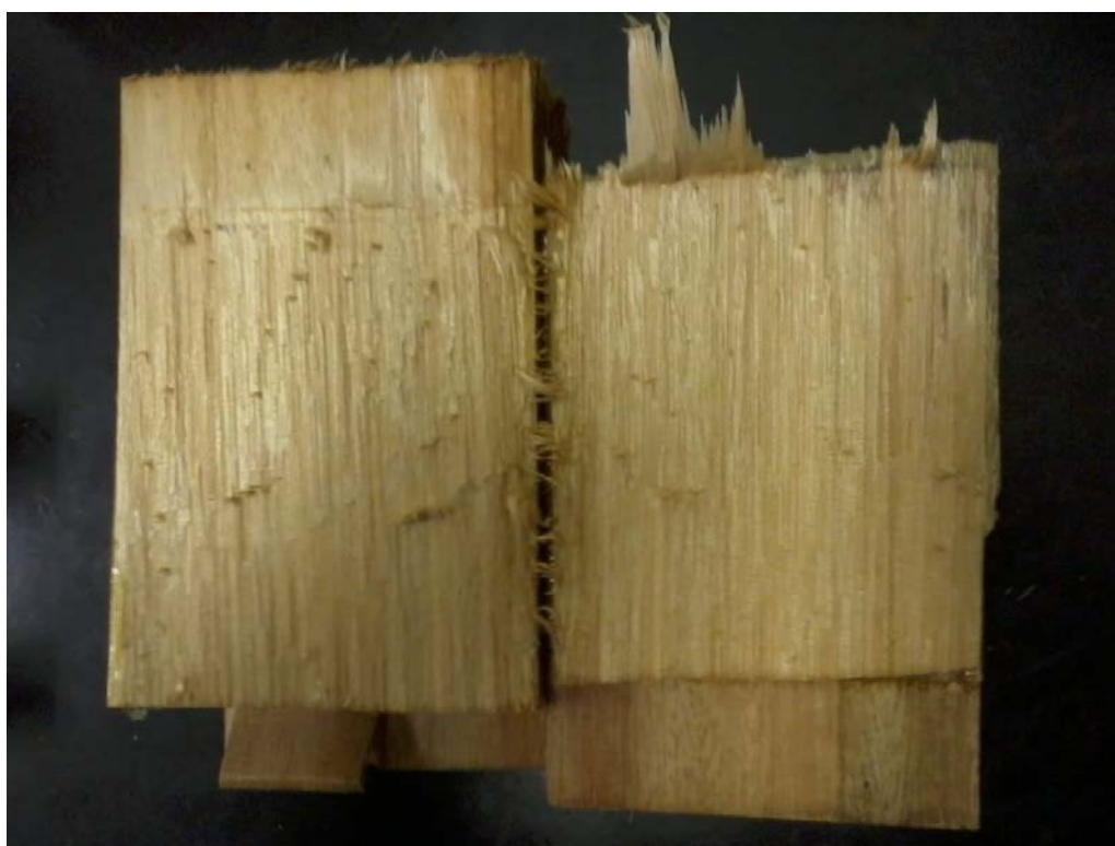
Figura 19 – Modo de ruptura predominante após imersão em água durante 12 horas
