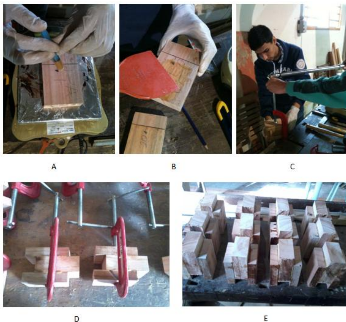
Figura 9 – Processos de fabricação dos corpos de prova: A) aplicação do adesivo na área de cola; B) distribuição do adesivo na área de cola; C) prensagem do corpo de prova; D) corpos de prova em descanso durante 24 horas; E) corpos de prova finalizados
