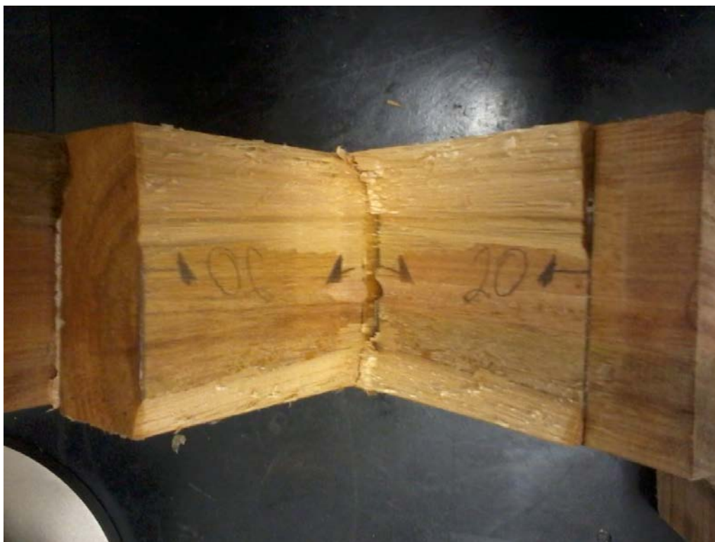
Figura 20 – Modo de ruptura predominante após imersão em água durante 24 horas
