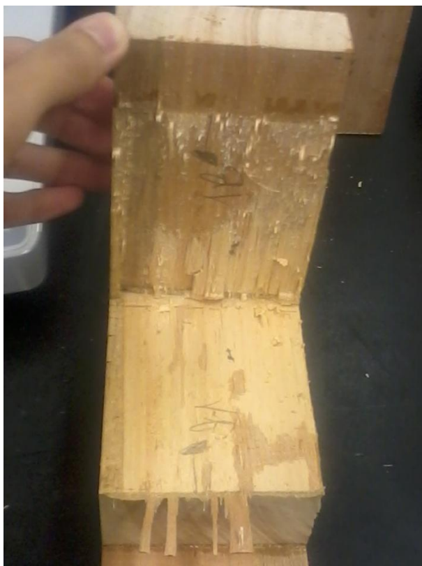
Figura 13 – Modo de ruptura predominante na colagem a 8% de teor de umidade
