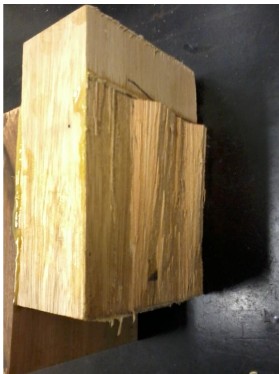
Figura 15 – Modo de ruptura predominante na colagem a 12% de teor de umidade
