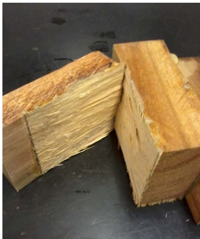
Figura 21 – Modo de ruptura predominante após imersão em água durante 36 horas
