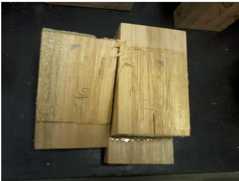
Figura 14 – Modo de ruptura predominante na colagem a 10% de teor de umidade
