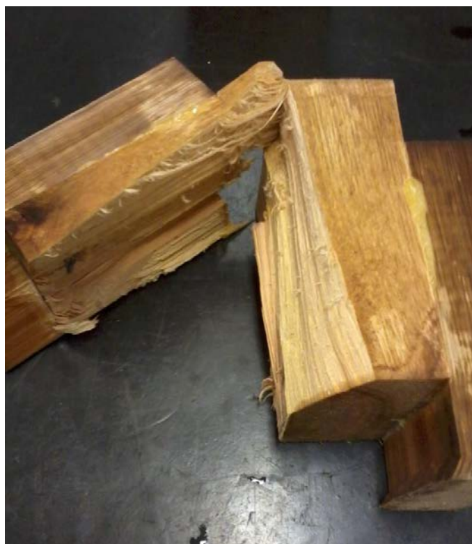
Figura 22 – Modo de ruptura predominante após imersão em água durante 48 horas
