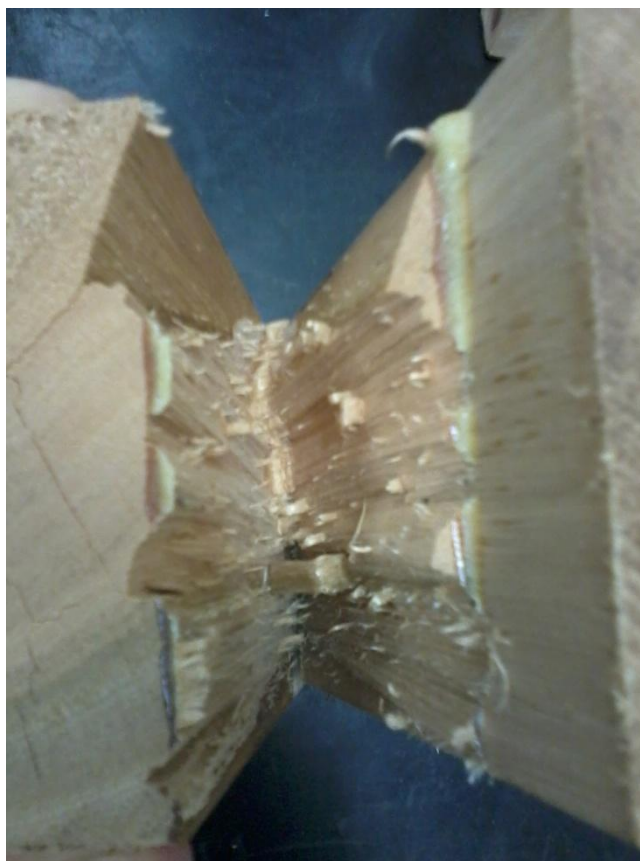
Figura 17 – Modo de ruptura predominante na colagem a 16% de teor de umidade
