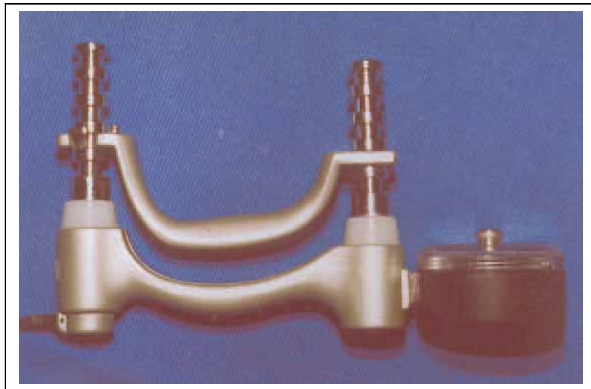
Figura 14: Dinamômetro JAMAR® ajustado na segunda posição.
