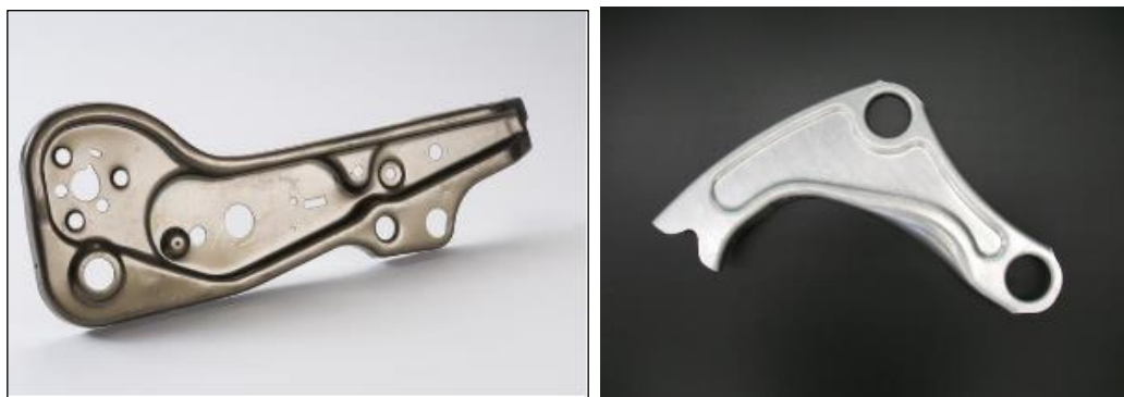
Figura 2.7: Exemplo de aplicações dos aços CP em componente BIW: flange do assento e braço da suspensão respectivamente
