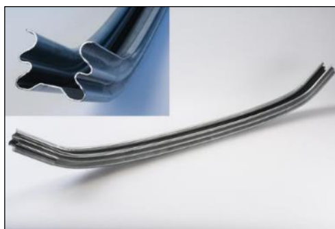
Figura 2.5: Exemplo de aplicação dos aços TRIP em componente BIW: travessa de para-choque
